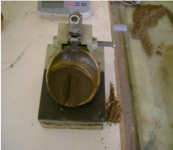
PRUEBA LIMITES DE CONSISTENCIA
