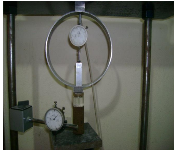
PRUEBA COMPRESIÓN SIMPLE
