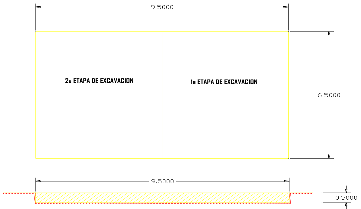
FIGURA 22 ETAPAS DE EXCAVACION
