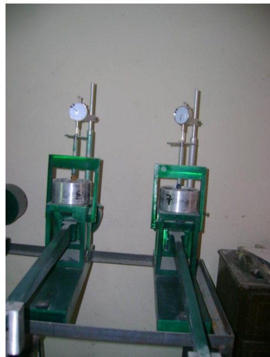
PRUEBA DE CONSOLIDACIÓN
