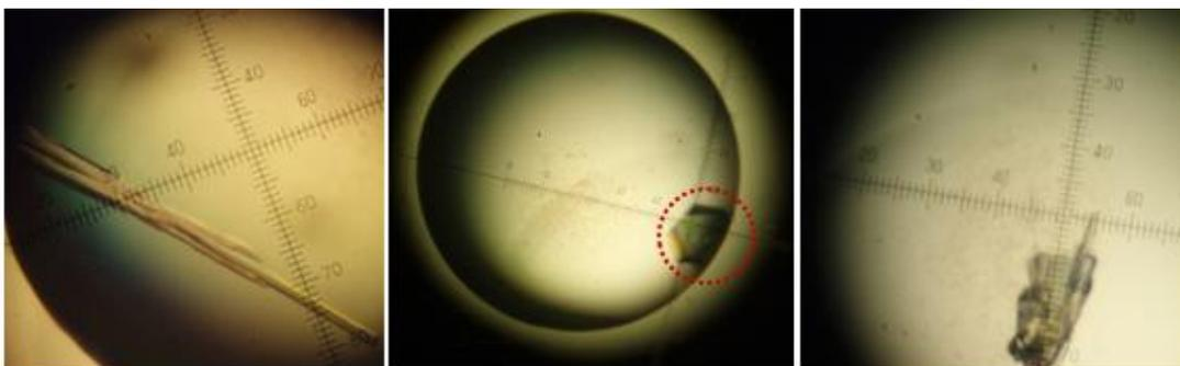
**Figura 17.** Cristales crecidos a una concentración de *LvTrx* de  $6 \text{ mg mL}^{-1}$ , acetato de sodio  $10 \text{ mM}$  pH 3.8 (sulfato de amonio  $2.0 \text{ M}$ , acetato de sodio  $0.1 \text{ M}$  pH 4.6) en ausencia de DTT a  $18^\circ\text{C}$ , el círculo rojo indica el cristal que se tomó para ser difractado.
