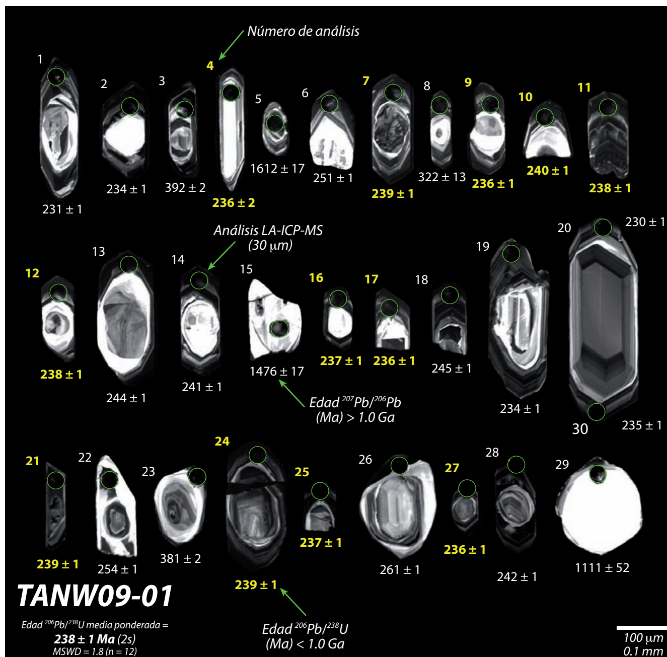
Figura B16. Imagen de cátodoluminiscencia (CL) post-ablación de zirrones obtenida utilizando un microscopio electrónico de barrido (SEM, Scanning Electron Microscope) con detector de cátodoluminiscencia (CL). Como se indica en la figura, los círculos de color verde muestran el lugar de ablación y debajo de cada zircón la edad determinada en ese punto del zircón. Estos zirrones pertenecen a la muestra de leucogranito de dos micas TANW09-01 recolectada en el sector noroeste de Sierra Los Tanques. La edad individual reportada para cada zircón es una edad a precisión de 1 sigma. La edad ^{206}\text{Pb}/^{238}\text{U} media ponderada, interpretada como la edad de cristalización de esta muestra de leucogranito, es de 238 \pm 1 \text{ Ma} (MSWD = 1.8, n = 12), reportada a precisión 2 sigma.
