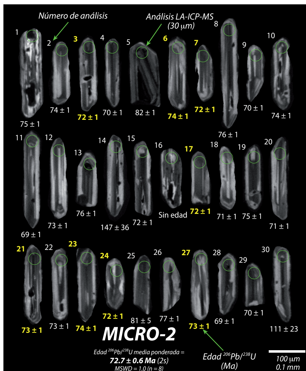
Figura B22. Imagen de cátodoluminiscencia (CL) pre-ablación de zircones obtenida utilizando un microscopio electrónico de barrido (SEM, Scanning Electron Microscope) con detector de cátodoluminiscencia (CL). Como se indica en la figura, los círculos de color verde muestran el lugar de ablación y debajo de cada zircón la edad determinada en ese punto del zircón. Estos zircones pertenecen a la muestra laramídica de microdiorita MICRO-2 recolectada en el sector noroeste de Sierra Los Tanques. La edad individual reportada para cada zircón es una edad a precisión de 1 sigma. La edad ^{206}\text{Pb}/^{238}\text{U} media ponderada, interpretada como la edad de cristalización de esta muestra de microdiorita, es de 72.7 \pm 0.6 Ma (MSWD = 1.0, n = 8), reportada a precisión 2 sigma.
