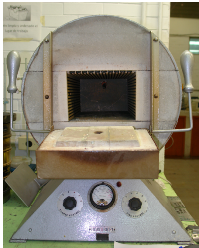
Figura 3.3 Horno eléctrico marca Hevi Duty para pruebas de cocción
