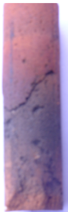
Figura 4.3 a) Espécimen con composición 60-40 lodo-arcilla, 1050 °C.
