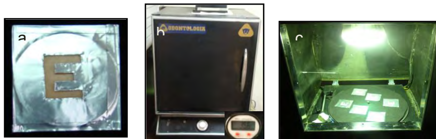
Figura 9. Muestra en un sobre de papel aluminio (a). Cámara de Envejecimiento Acelerado a 35 °C (b). Muestras en una mesa giratoria expuestas a luz UV (c).
