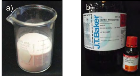
Figura 5. PMMA experimental (a). MMA y dimetil-p-toluidina (b).
