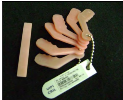
Figura 20. Comparación de una muestra de PMMA experimental con resinas acrílicas comerciales
