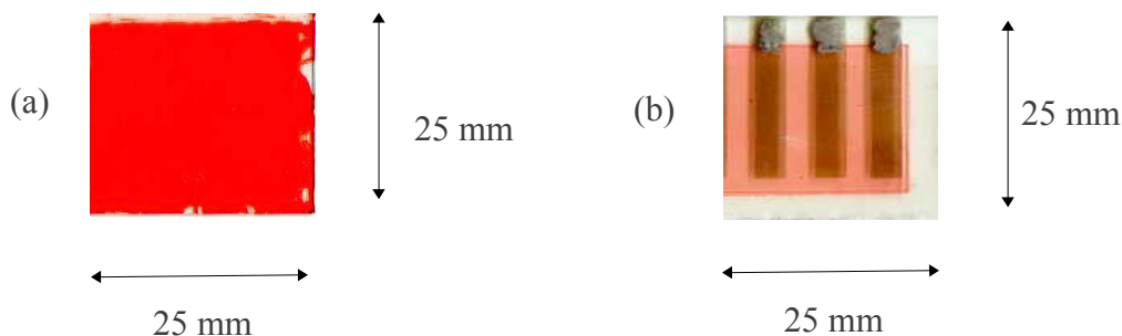
Figura IV.4: Fotografías de (a) una muestra recién fabricada y (b) de un diodo para las mediciones de EAS, ambas sobre sustratos de vidrio con ITO.
