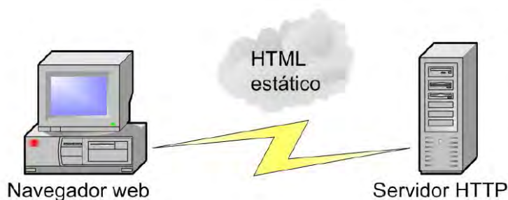
Figura 3.1 HTML estático: Configuración típica de una "aplicación web" que se limita a ofrecer la información almacenada en páginas HTML a las que el usuario final accede desde su navegador web.
