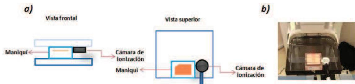
Figura 4.11. a) Esquema de medición de la dosis glandular promedio, b) El maniquí de acreditación se encuentra centrado sobre el soporte y la cámara de ionización se coloca junto al maniquí.
