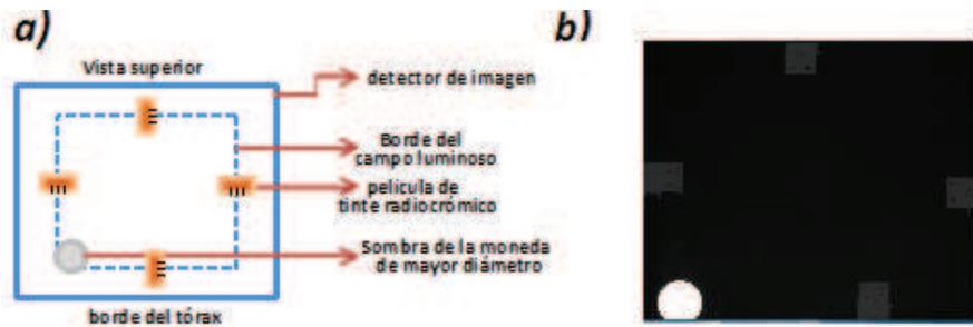
Figura 4.5. a) Montaje de la prueba de colimación en un mastógrafo digital DR, b) Se puede observar una imagen radiográfica para el análisis de la prueba de colimación en un equipo digital DR, se pueden observar las imágenes de la película de tinte radiocrómico, las cuales se alinean con el borde del campo luminoso.
