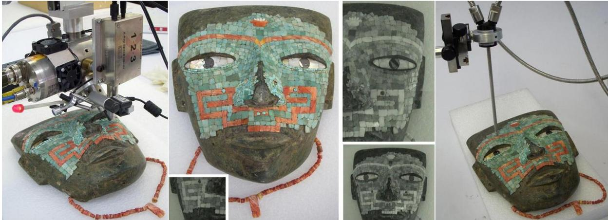
Fig. 1.4 En ella se muestran las distintas técnicas aplicadas en el estudio de la máscara de Malinaltepec: XRF (izquierda), imagen infrarroja (centro) y análisis FTIR (derecha) [20].
