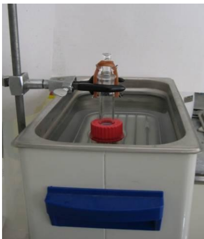
Figura 11. CEMAUF-SR. Extracción de la muestra utilizando el sistema cerrado (celda con tapón)
