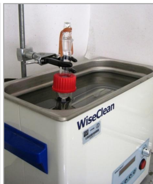
Figura 8. Extracción usando la celda en el sistema cerrado CEMAUF-SR
