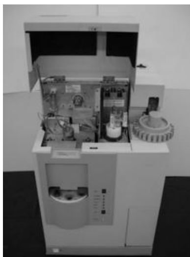
Figura 4. Extractor EFS Hewlett Packard modelo 7680T Tomado de http://www.ebay.com
