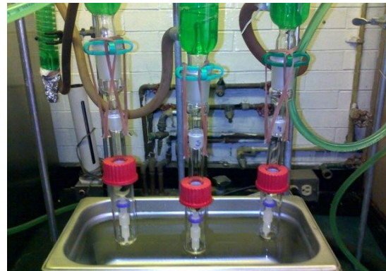
Figura 22. Celdas acopladas a los condensadores
