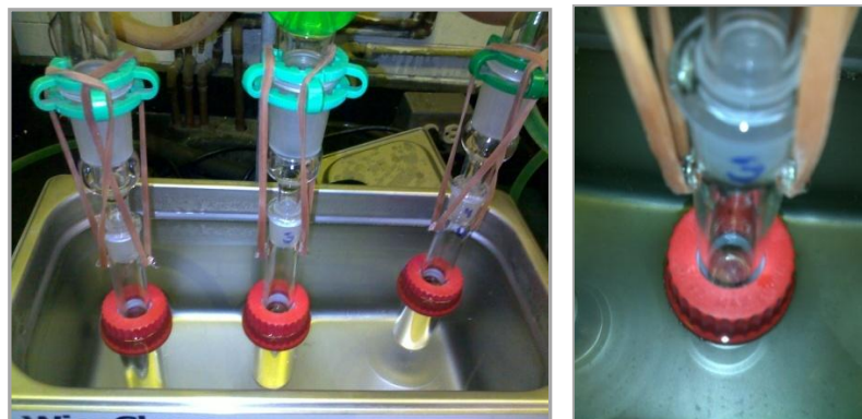
Figura 23. Extracción dentro del baño ultrasónico
