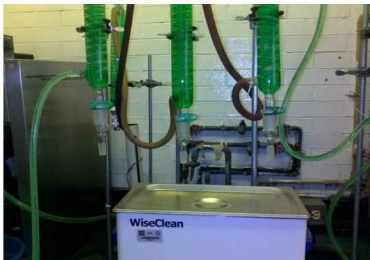
Figura 21. Condensadores con conectores de juntas esmeriladas
