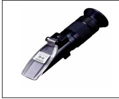
Fig. 10. Refractómetro empleado en este estudio marca ATAGO modelo N-3E.
