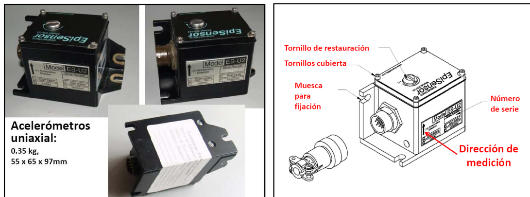
Fig. 3.18 Características acelerómetro uniaxial
