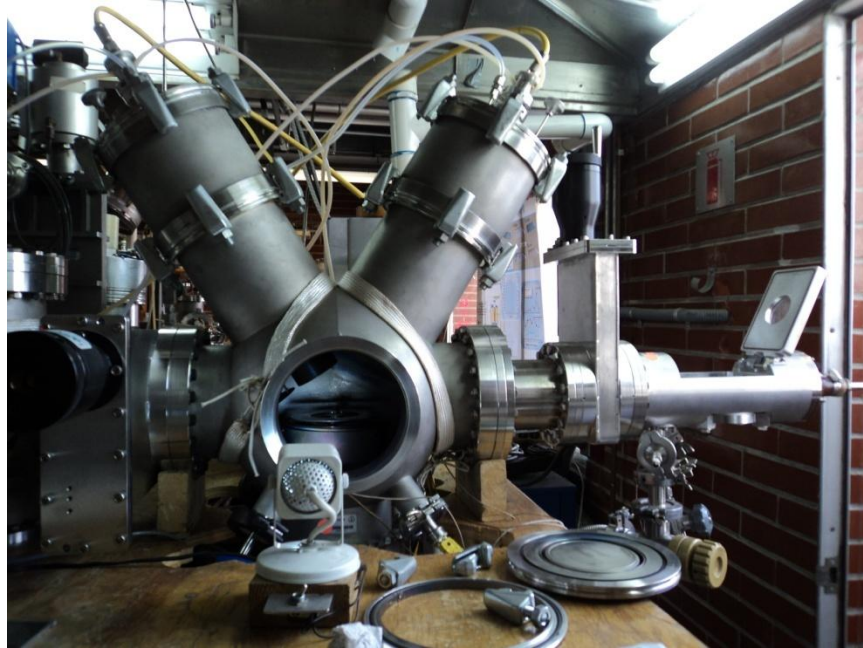
Figura 2.1: Sistema de Sputtering de doble cátodo con fuente de corriente directa y fuente de radiofrecuencia.
