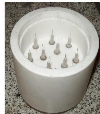
**Fig.3.7** Simulador de lluvia de teflón, empleado durante el experimento.
