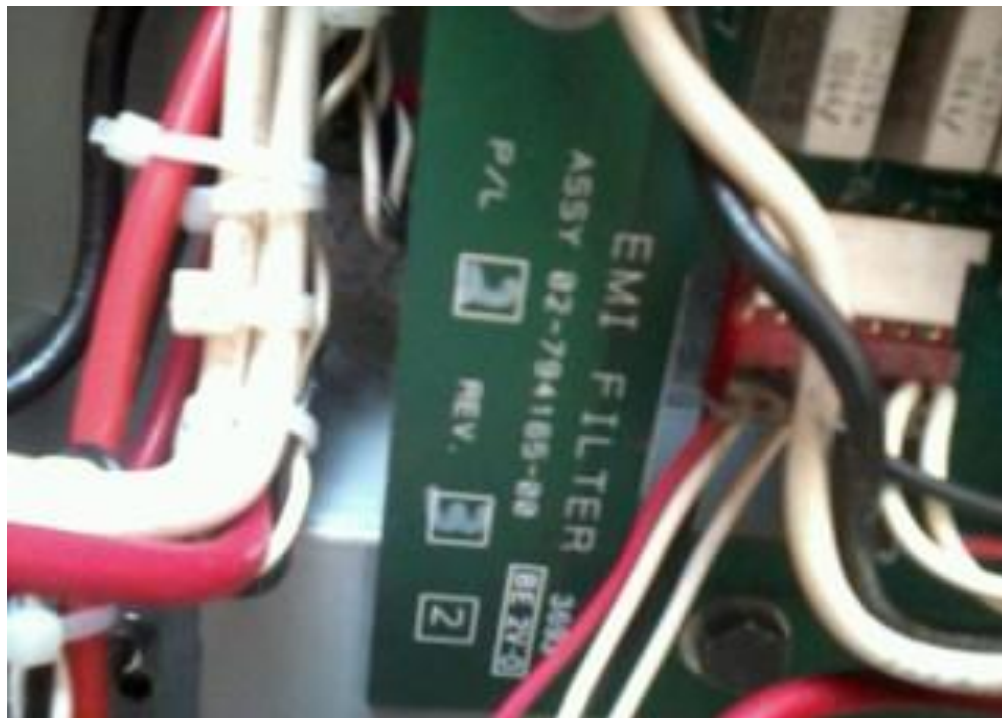
Figura 3.4 Tarjeta del filtro para ruidos EMI
