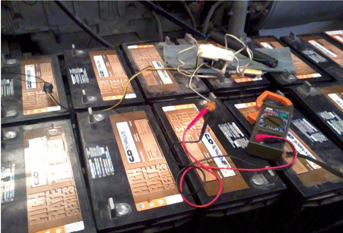
Figura 3.14 Prueba por resistencia a baterías
