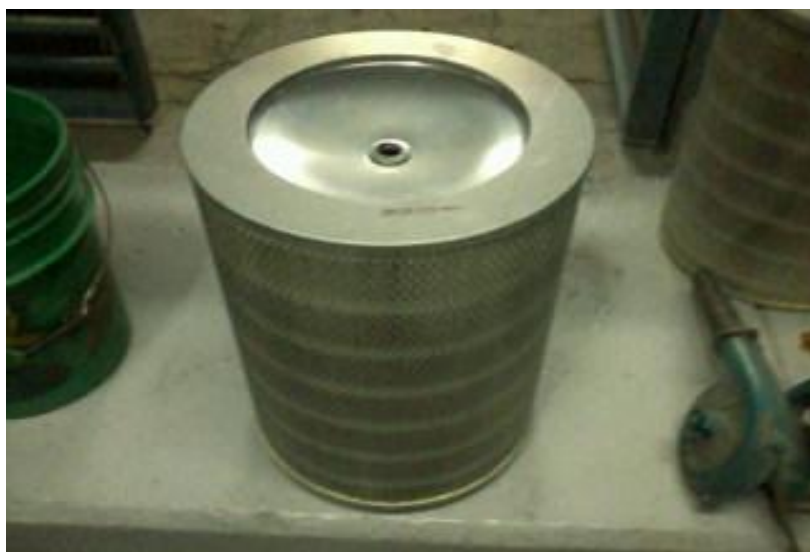
Figura 2.5 Filtro de aire
