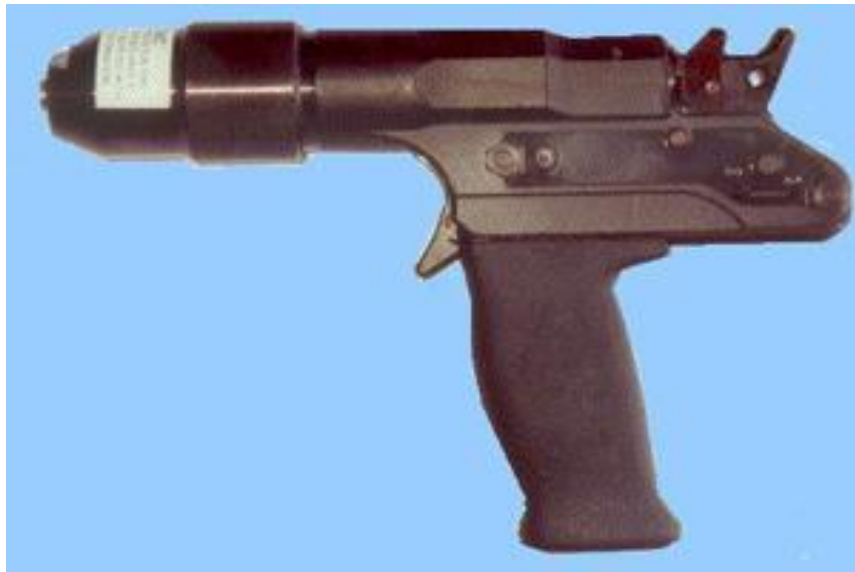
Pistolete de perno cautivo de penetración. Su peso es de 6 KG aproximadamente
