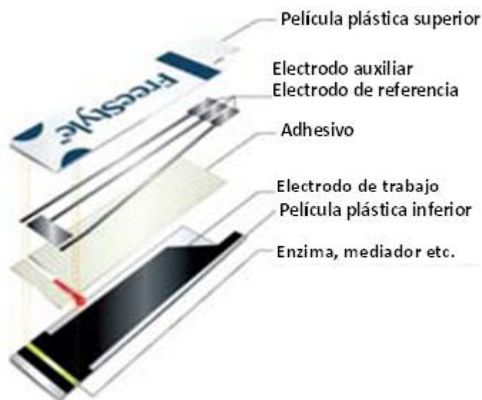
Figura A2 Distintas partes de un sensor de glucosa de la casa Freestyle.
