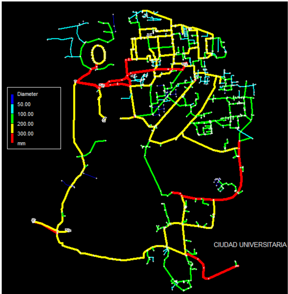
Figura 3.5 Distribución de las tuberías según el diámetro.
