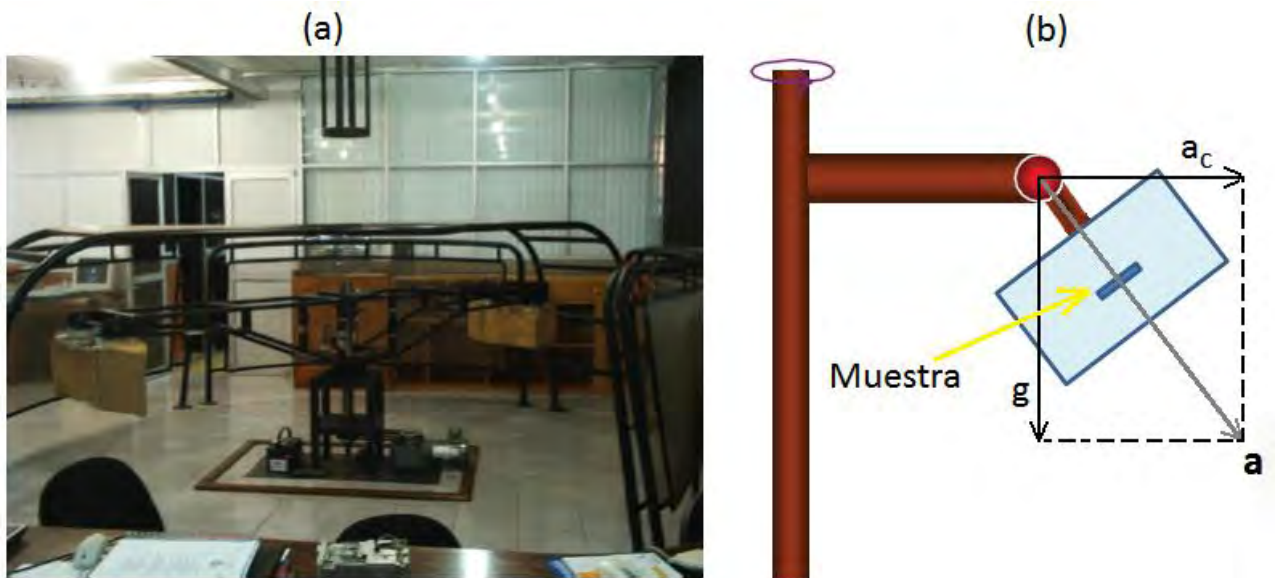
Fig. 4.2. (a) Centrifuga empleada para el secado de las muestras bajo condiciones de supergravedad (b) Canastilla articulada para mantener las muestras. Aceleración de la gravedad ( g ); Aceleración centrifuga ( a_c = \omega^2 R ) donde \omega es la velocidad angular y R es la distancia desde la muestra al eje de rotación; Aceleración total ( a ). 149
