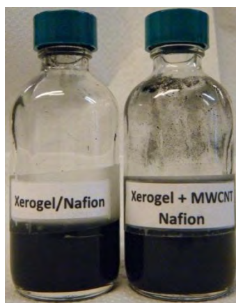
Fig. 4.6. Tintas CX-Nafion y CX-MWCNT-Nafion.
