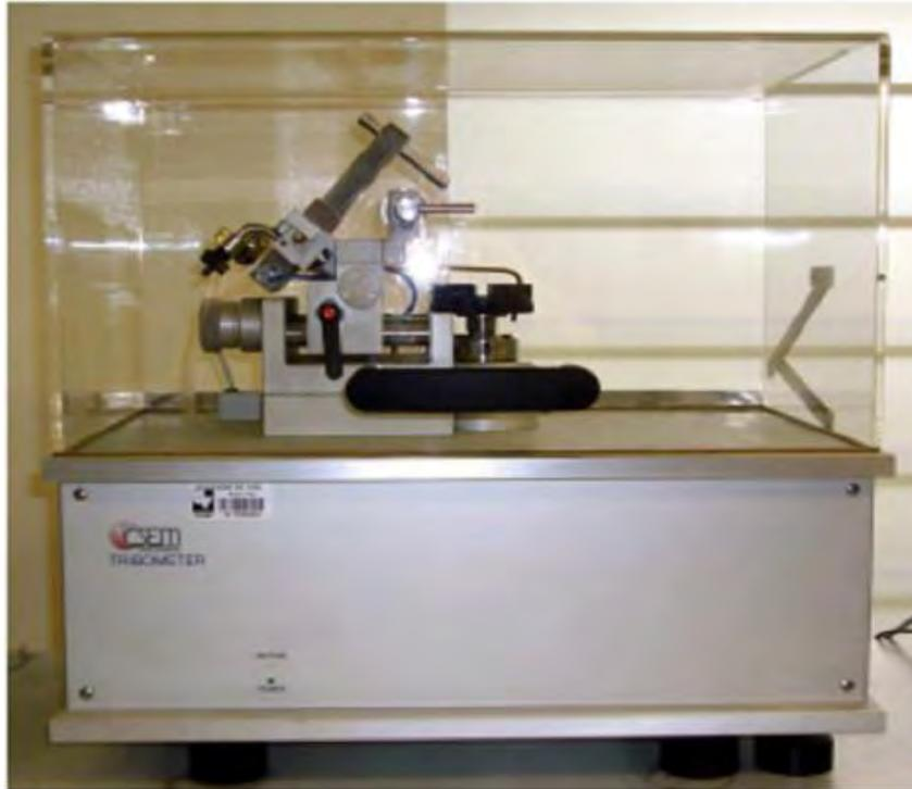
Figura 3.6. Tribómetro pin-on-disc CSEM de la UNIVERSIDAD DEL VALLE Cali-Colombia.
