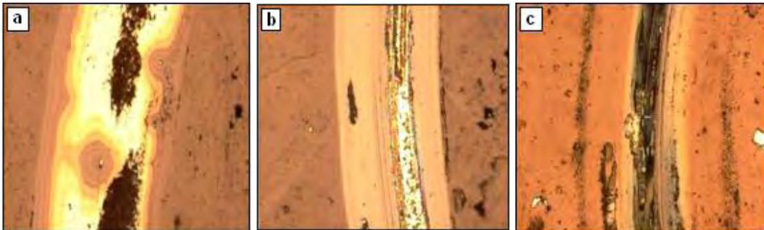
Figura 4.3.5. Micrografías ópticas de la pista de desgaste (100x) de recubrimientos de TiAlN sometidos a 1N de carga y 10 cm/s de velocidad utilizando diferentes materiales de contraparte: (a) 100Cr6, (b) Al<sub>2</sub>O<sub>3</sub>, (c) WC.
