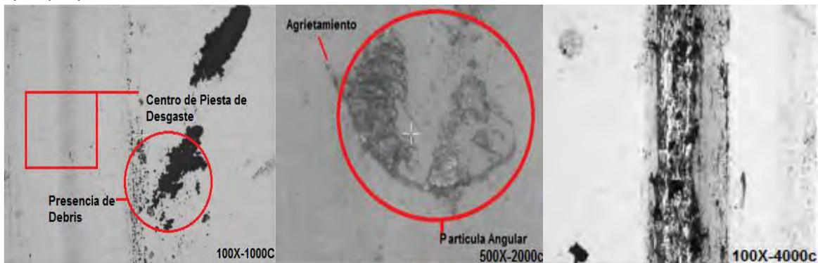
Figura 4.6.11. Micrografías ópticas de las huellas de desgaste a)1000 ciclos, b)2000ciclos y c)4000ciclos.
