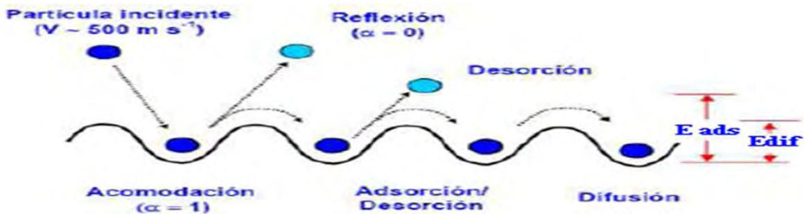
Figura 2.10. Esquema de las etapas iniciales de la llegada de átomos a una superficie y de los procesos de adsorción, desorción y difusión simultánea en la superficie [1]
