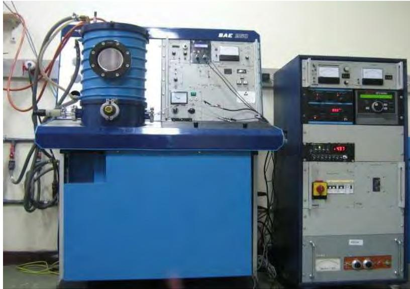
Figura 3.3 Sistema Magnetron Sputtering Balzers BAE 250 Laboratorio de Bajas Temperaturas Universidad del Cauca Popayan-Colombia.
