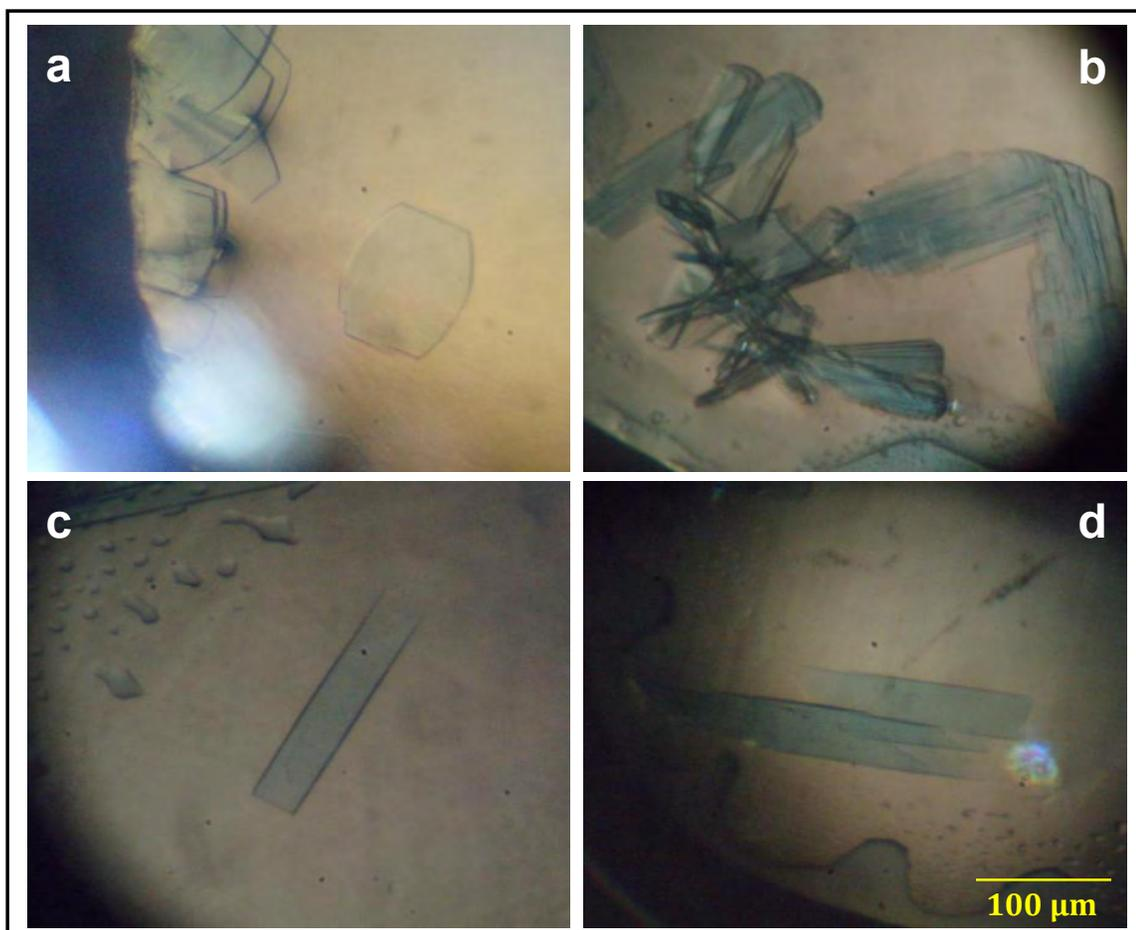
**Figura 16.** Cristales de la *Tth*-MCO crecidos a 4 °C en 0.1 M HEPES pH 7.5, concentración de proteína de 30 mg mL<sup>-1</sup> y diferentes porcentajes de MPD. **a)** Gota sedente, 60% (v/v) MPD, **b)** Gota colgante, 65% (v/v) MPD, **c)** Gota sedente, 70% (v/v) MPD, **d)** Micropuentes, 70% (v/v) MPD. Todas las fotografías se tomaron con la misma magnificación y sin polarizador para observar el color real de los cristales.
