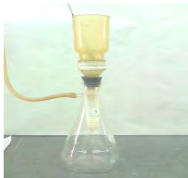
Fotografía 3.3: Obtención de la solución QUIMAC en equipo Millipore
