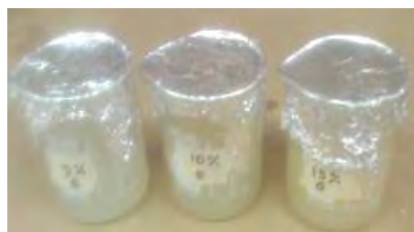
Fotografía 3.5: Soluciones plastificantes empleadas a diferentes concentraciones
