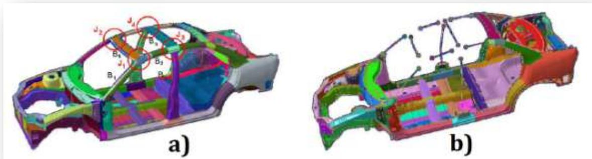
*Figura 1.11 a) Modelo original del cuerpo del automóvil, b) modelo con 10 elementos “shell” sustituidos con elementos viga [68].*
