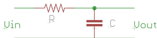
Figura 4.4: Filtro para convertir una señal de PWM en un voltaje analógico.
