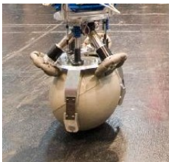
Figura 2.5: Esfera del Rezero con porta-esfera.
