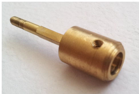
Figura 4.2: Acoplamiento entre el eje del motor y la rueda omnidireccional.
