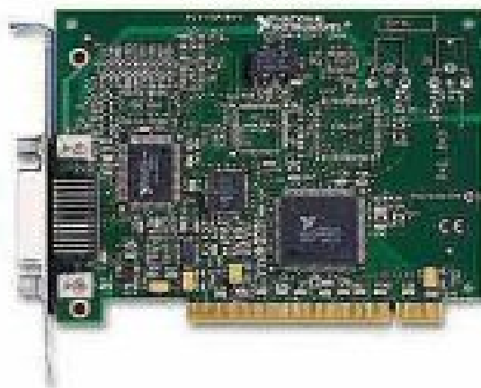
Figura 4.3: Tarjeta GPIB-PCI para computadoras.
