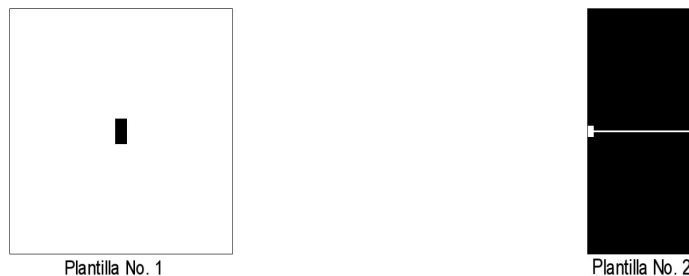
Figura 3.5: La plantilla No.1 es colocada sobre la fotorresina AZ3300. La plantilla No.2 es colocada sobre la fotorresina SU8-2000.
