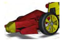
Los diseños estrechos y en forma de punta de avión reducen el efecto de vibración, ya que desvían las líneas de flujo del aire, ayudando a mantener el coeficiente de resistencia bajo. También ejerce su influencia el diseño de alerones o spoilers y tomas de aire que evacuen o desvíen el fluido.<sup>[12]</sup>
