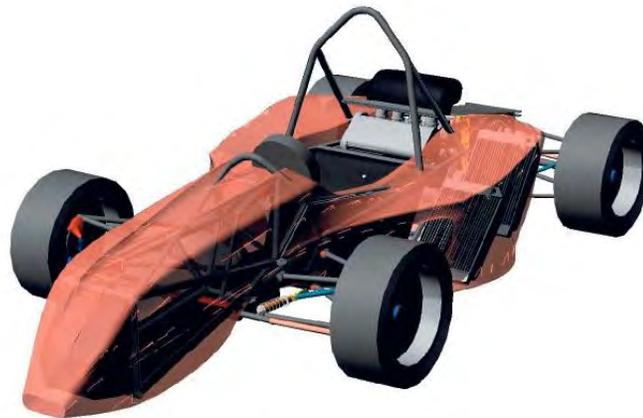
Fig. 2.4.3.1.a. Prototipo de Diseño Aerodinámico de la Carrocería de un Vehículo FSAE con ADMS.
