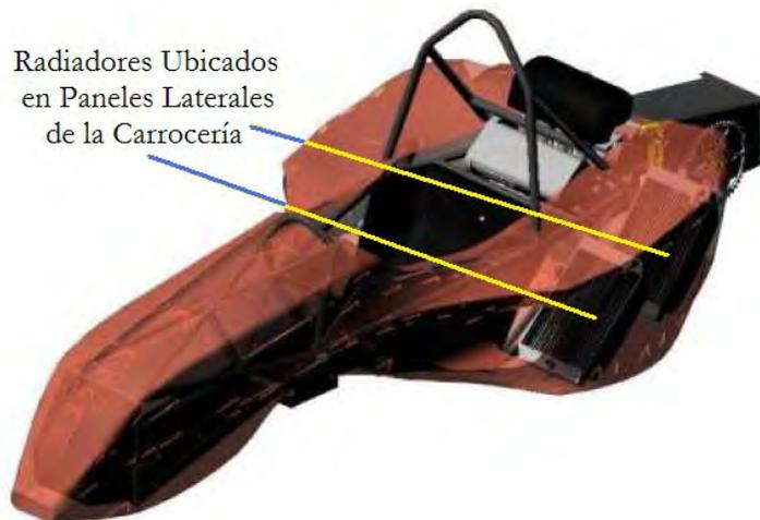
Fig. 4.1.2.6. Sistema de Enfriamiento por Aire (Paneles Laterales).
