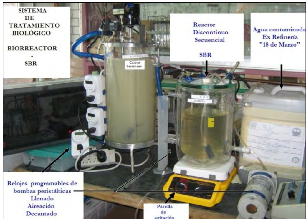
Figura 3.8 Incubación del consorcio en biorreactor para posteriores inoculaciones en SBR
