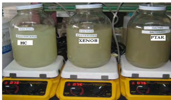
Figura 3.1 Incubación microbiana en biorreactores (de izquierda a derecha: C HC , C XENOB , C PTARCU )
