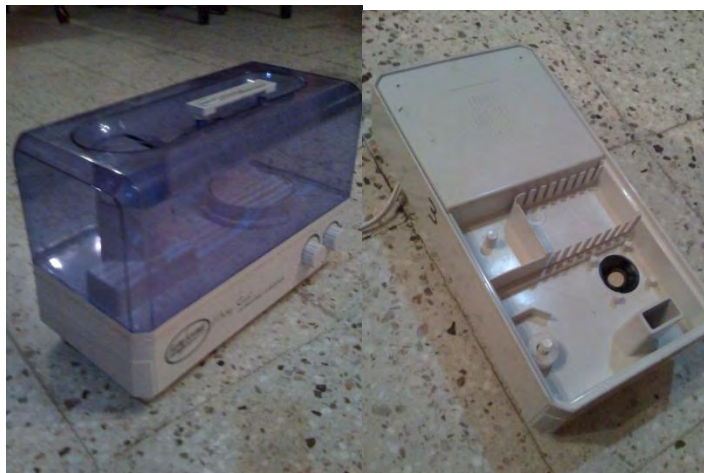
Figura 4.4.5 Modulo “Generador electrónico de niebla y humedad por ultrasonido”
