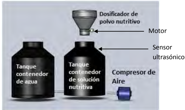
Figura 4.3.1.10 Diseño de configuración del Módulo Generador de Neblina Nutritiva.
