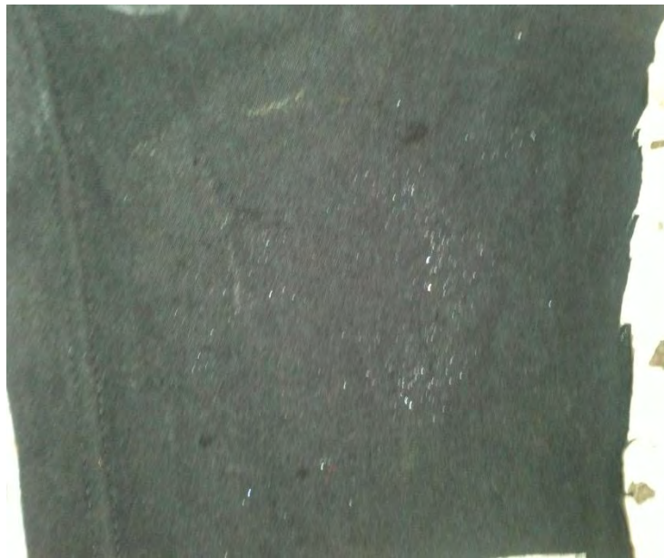
Figura 4.4.9 Resultado de la nebulización con sales visible en la tela negra.
