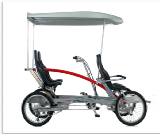
Imagen 2.1. Cuadríciclo 2 - Rider de 4 Plazas y estructura de aluminio. 23
