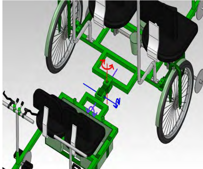
Imagen 5.21. Detalle sobre los grados de libertad o movilidad para el sistema de ensamble entre cuadríciclos.
