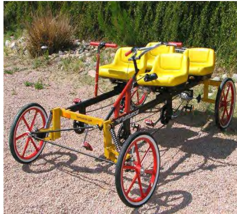
Imagen 2.5. El Tumtumcar V4 posee sistema de amortiguamiento independiente con la opción de ser híbrido en su transmisión de potencia. 26
