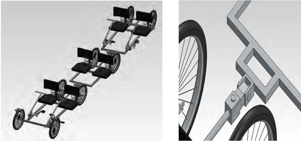
Imagen 5.6. Tren de cuadríciclos de configuración directriz –infantil - remolque motriz y detalle del gancho de conexión.
