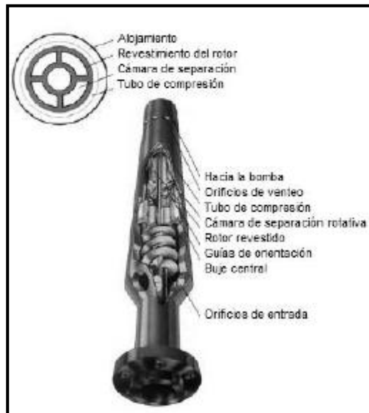
Figura 2.21 Separador de gas. 2
