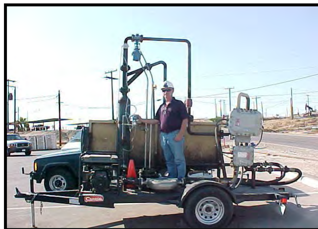
Figura 4.9 GLCC portátil utilizado en Bakersfield, California, Estados Unidos. 3
