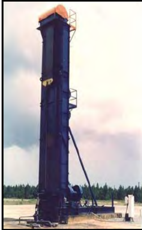
Figura 2.26 Unidad de carrera extra-larga Rotaflex. 13
