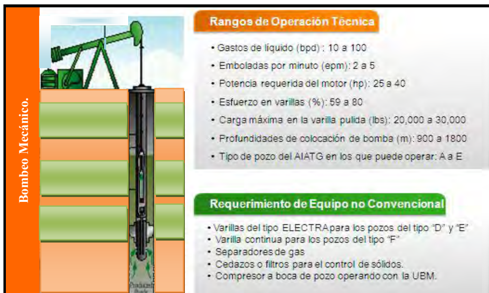
Figura 2.22 Especificaciones del BM aplicado en el AIATG. 1
