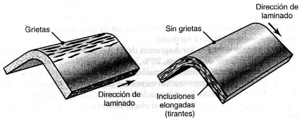
Figura 1.36 Relación de las inclusiones elongadas (tirantes) y la dirección de laminado xxxvii .
