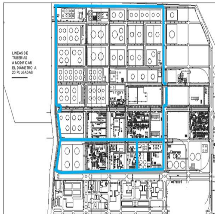
Figura 16 Tramo de tubería a sustituir en diámetro.
