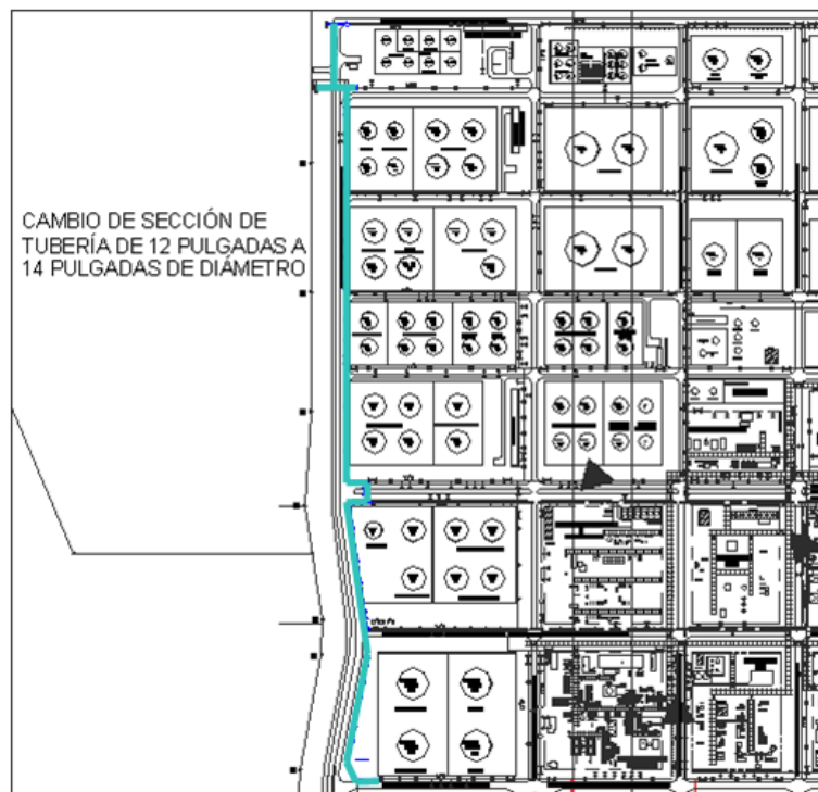
Figura 15 Tramo de tubería a modificar en diámetro de 12 a 14 pulgadas.
