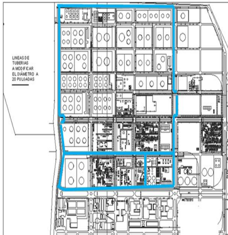
Figura 18 Propuesta 3 “Renovación del sistema PCI”
