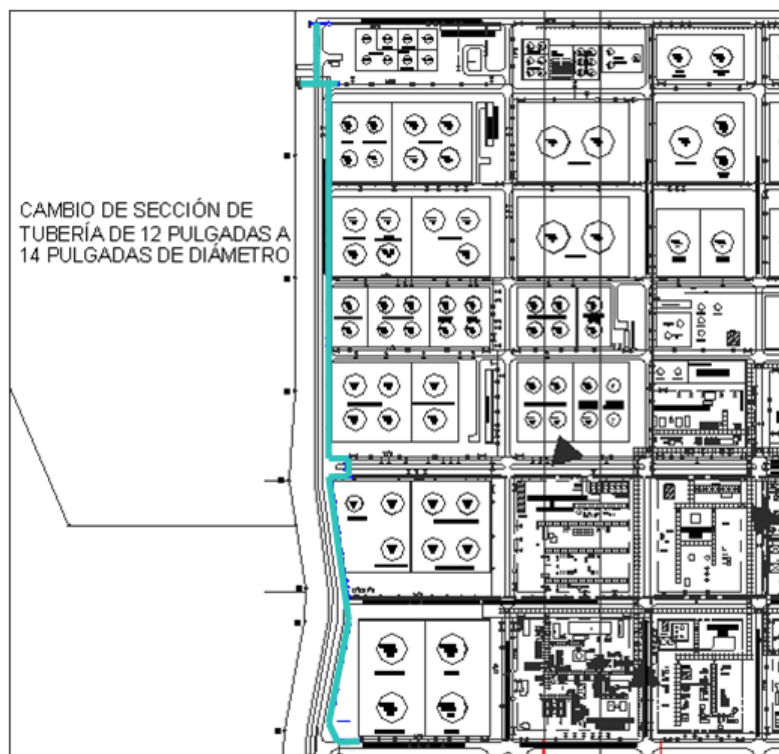
Figura 17 Propuesta 2 “Rehabilitación del sistema PCI”
