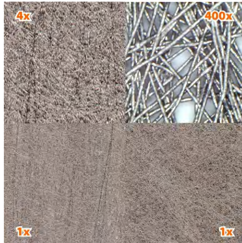
Imagen 51. Filtro HNV80 con diversos acercamientos. Fuente: electrocontaminación.net (Consulta: 26 de Noviembre 2011)
