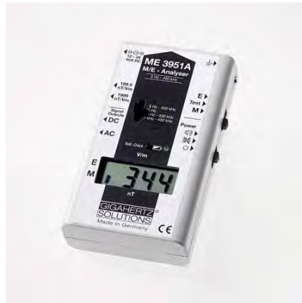
Imagen 68. Medidor ME3951A. Fuente: http://www.electrocontaminación.net (Consulta: 26 de Noviembre 2011)
