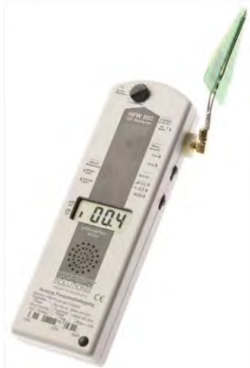
Imagen 78. Medidor HFW35C. Fuente: http://www.electrocontaminación.net (Consulta: 26 de Noviembre 2011)
