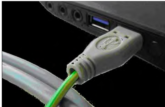
Imagen 40. Cable EST-USB Schuko. Fuente: electrocontaminación.net (Consulta: 26 de Noviembre 2011)
