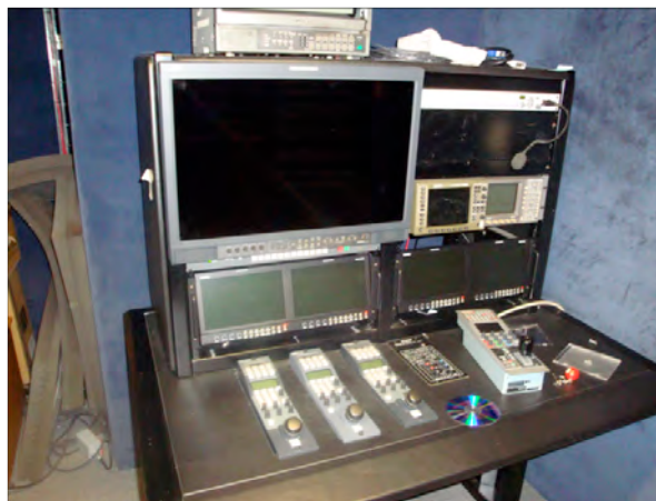
Figura 3-2 Unidad de control de cámaras (CCU), auxiliado por un monitor de imagen por cámara y un monitor forma de onda para revisar que todos los niveles de video estén conforme a la norma NTSC.
