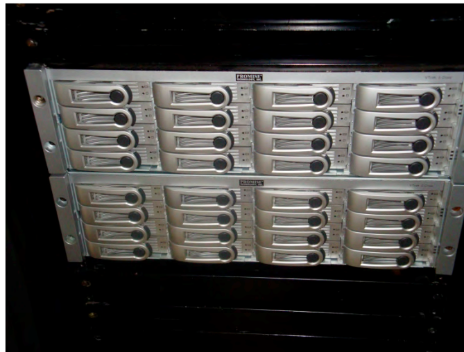
Figura 5-6. Arreglo de Discos Marca Promise Clase E y J
