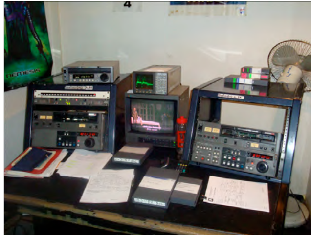
Figura 3-12. Isla de edición lineal en donde se observan las dos máquinas betacam SP, los monitores forma de onda y de imagen y su monitor de audio stereo.
