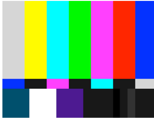
Figura 1-10. Señal de barras NTSC para ajuste de video [5].
