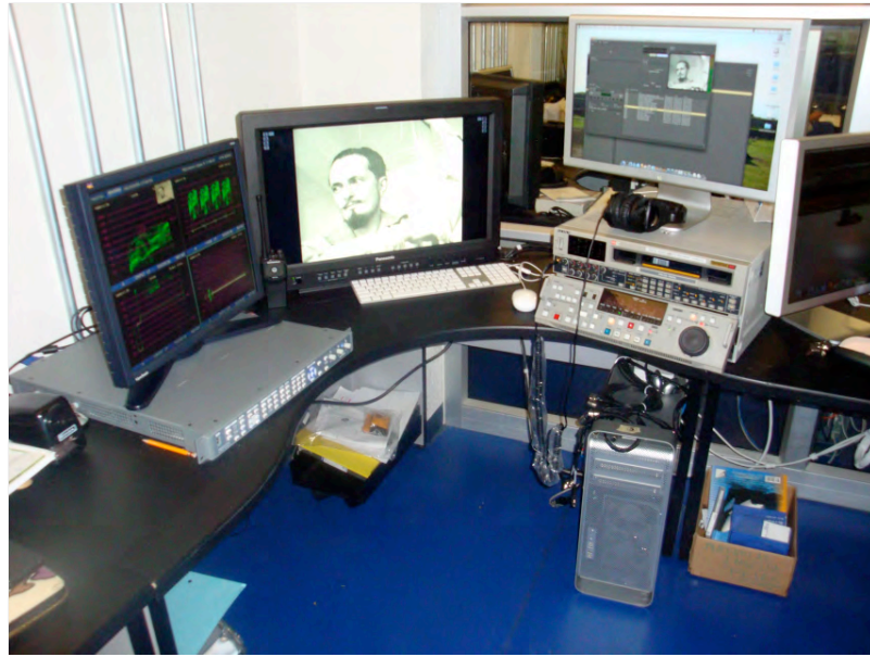
Figura 5-20. Terminal de ingesta compuesta por una computadora modelo Mac pro, una máquina Betacam SX, rasterizador y monitor de imagen de 24 pulgadas.
