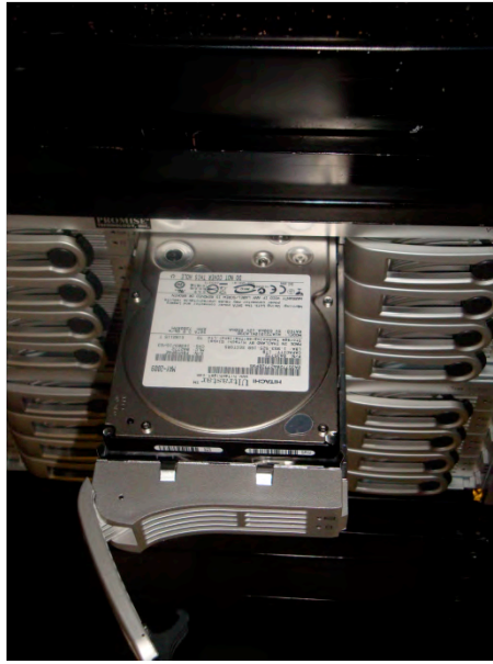
Figura 5-7. Disco duro de 1 TB de capacidad de un arreglo promise clase E.
