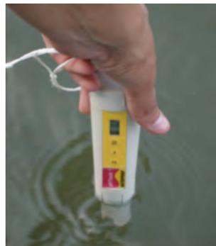
Fig. 11. Potenciómetro modelo Waterproof pH Testr 1.
