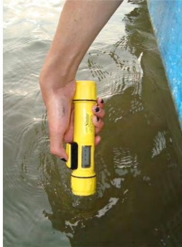
Fig. 7. Ecosonda portátil Depthmate, SM-5.
