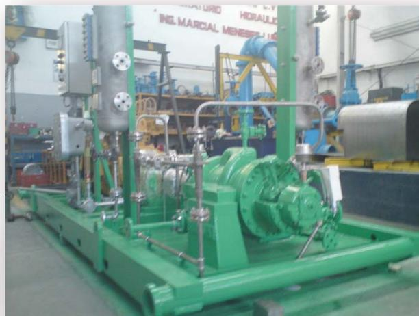
Fig. 15 Bomba centrífuga utilizada en instalaciones del campo Chicontepec.
