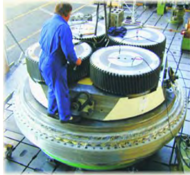
Figura 2.7. Multiplicador del tren de fuerza tipo A para un aerogenerador de 5 MW.
