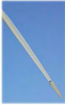
Figura 2.10. Freno aerodinámico de un alabe de turbina, en posición activada.
