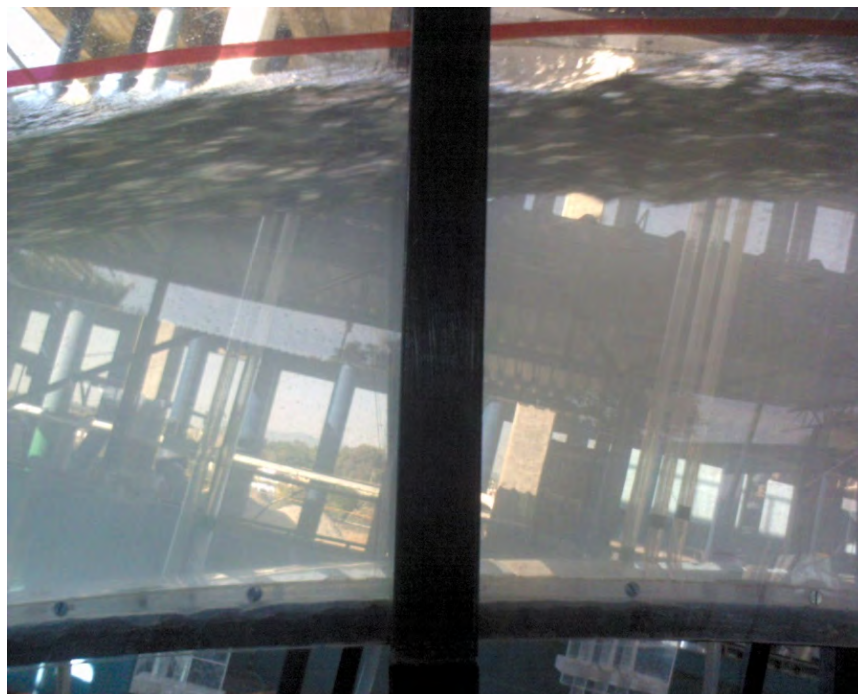
Fig. 3.41 Curva vertical del modelo hidráulico 1:30 para gasto máximo (Laboratorio de Hidráulica, CFE, 2010)
