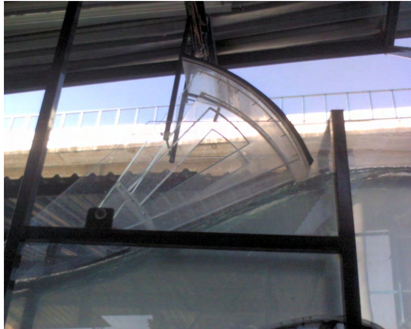
Fig. 3.40 Compuerta totalmente abierta para gasto máximo en modelo 1:30 (Laboratorio de Hidráulica, CFE, 2010)
