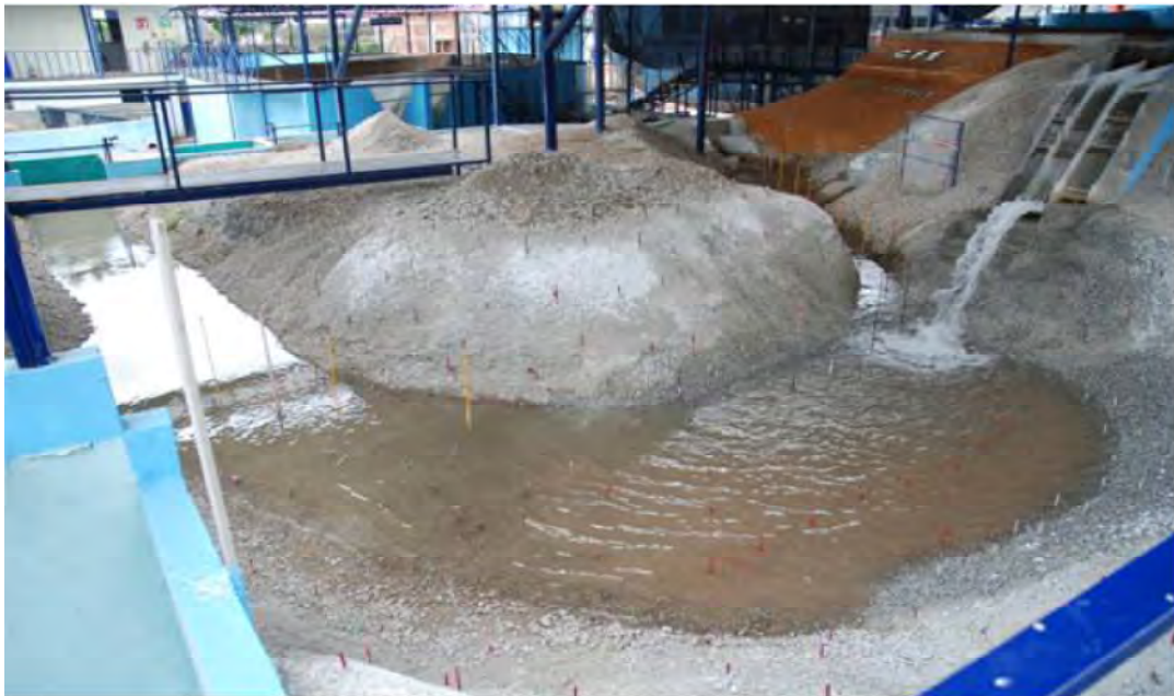
Figura 5.18 Descarga del flujo por el canal central para un gasto de 850 \text{ m}^3/\text{s} (Laboratorio de Hidráulica, CFE, 2007)
