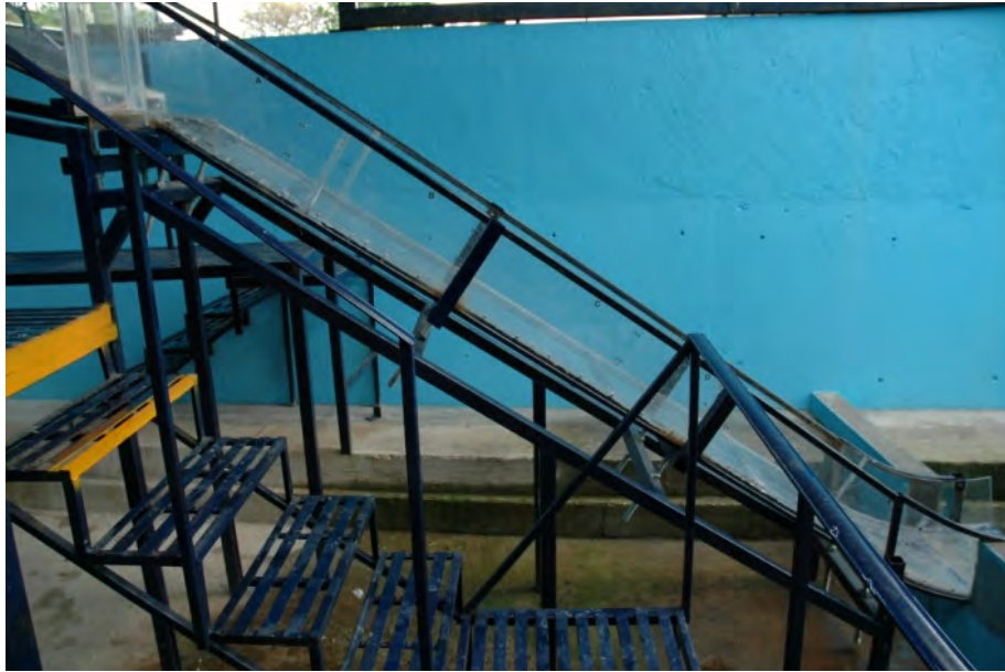
Figura 4.25 Rápida del modelo hidráulico aguas abajo del aireador escala 1:30 (Laboratorio de Hidráulica, CFE, 2010)
