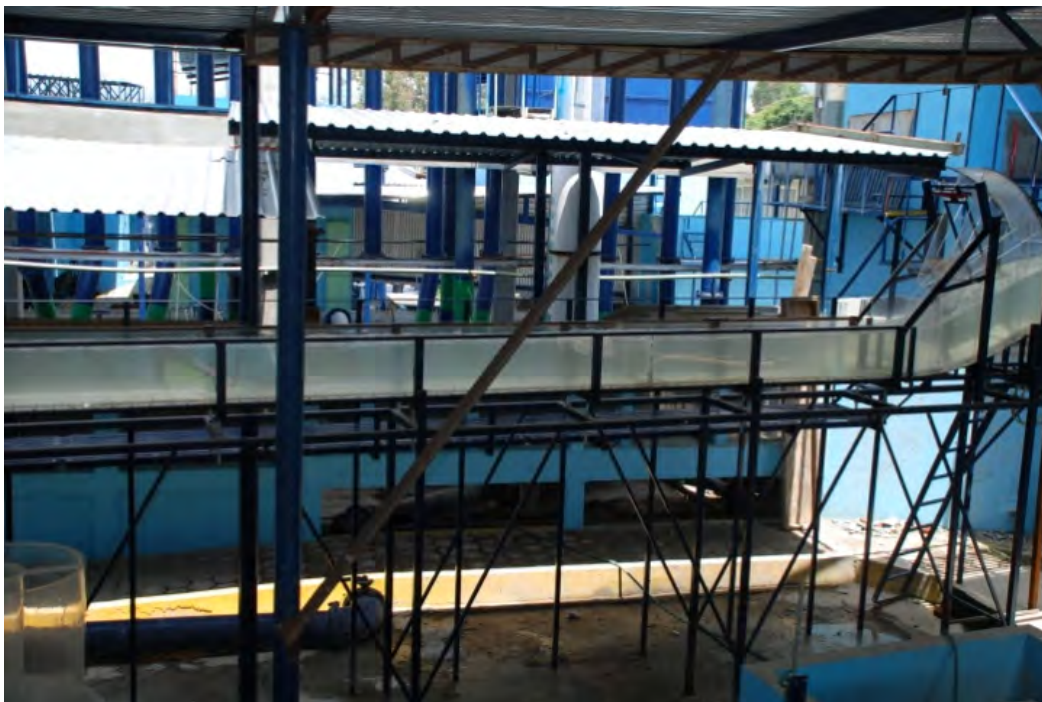
Figura 4.38 Flujo de agua a través del modelo hidráulico para gasto máximo de 15 110 (m 3 /s) equivalente a 5 037 (m 3 /s) en prototipo (Laboratorio de Hidráulica, CFE, 2010)
