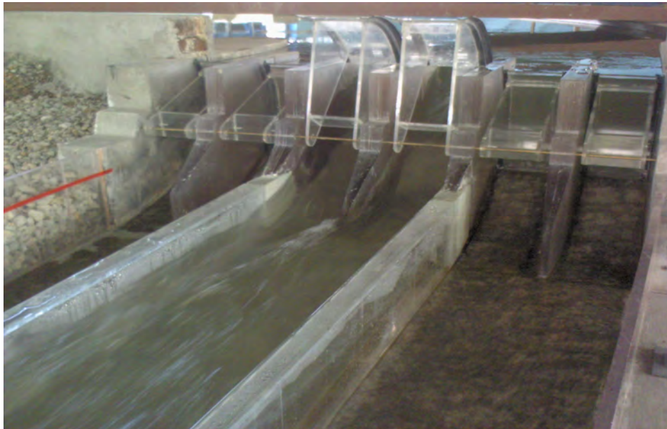
Figura 3.11 Compuertas en el modelo 1:75 (Laboratorio de Hidráulica, CFE, 2010)
