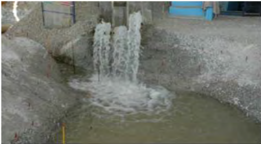
Figura 5.26 Descarga del flujo por los tres canales. Gasto de 850 m 3 /s por canal, para un gasto total de 2550 m 3 /s (Laboratorio de Hidráulica, CFE, 2007)
