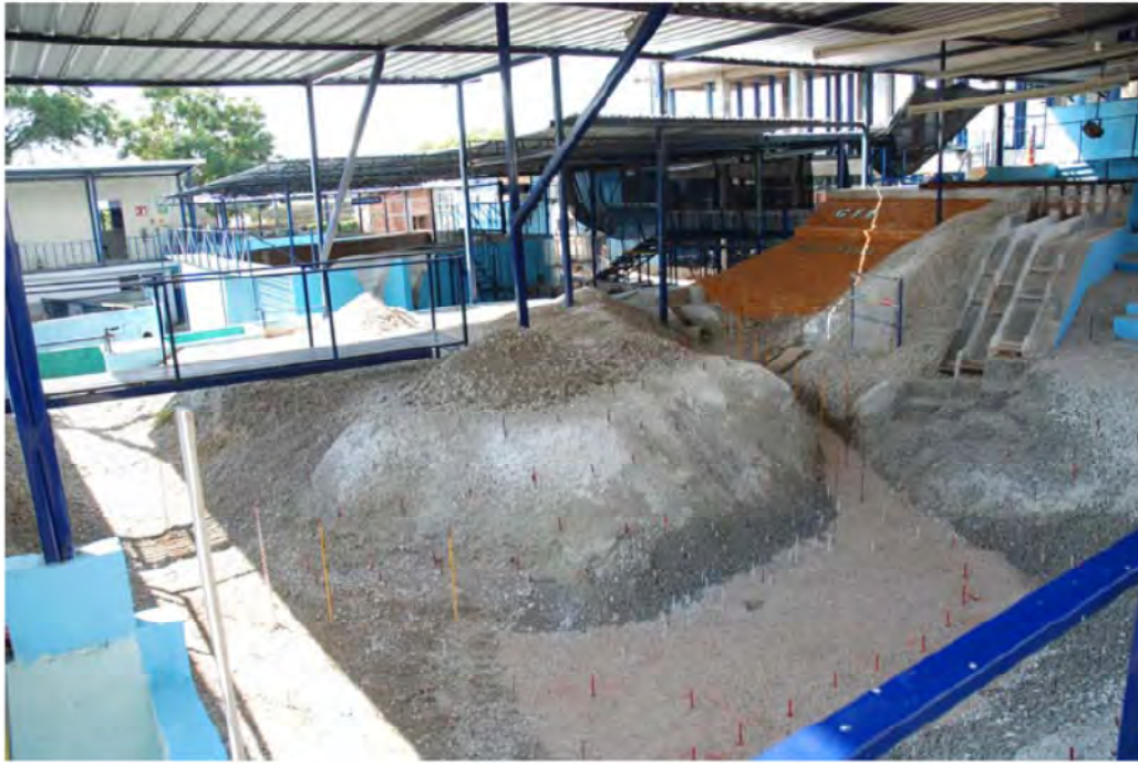
Figura 5.7 Modelo hidráulico del cauce en el laboratorio (Laboratorio de Hidráulica, CFE, 2007)
