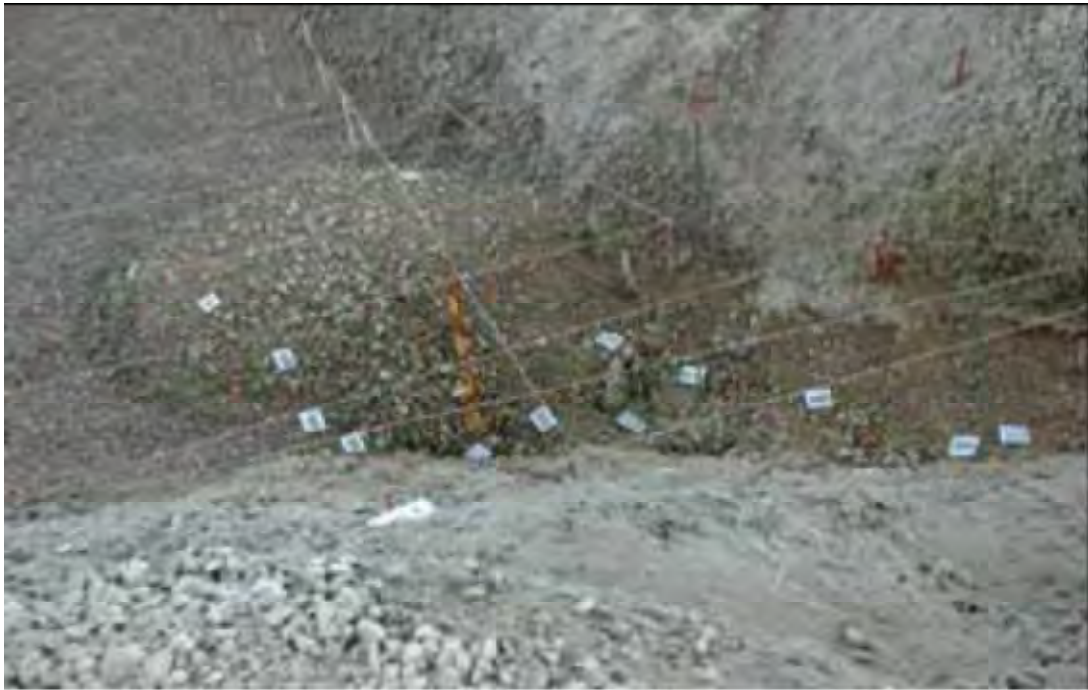
Figura 5.29 Erosión-depósito de material del cauce en modelo hidráulico para un gasto de 850 \text{ m}^3/\text{s} por canal, operando los tres canales (Laboratorio de Hidráulica, CFE, 2007)
