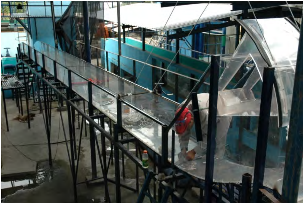
Figura 4.22 Modelo hidráulico del Laboratorio escala 1:30 (Laboratorio de Hidráulica, CFE, 2010)
