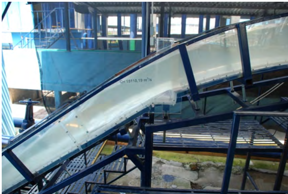
Figura 4.42 Flujo de agua a través del aireador en modelo hidráulico para gasto máximo de 15 110 ( m^3/s ) equivalentes a 5 037 ( m^3/s ) en prototipo (Laboratorio de Hidráulica, CFE, 2010)
