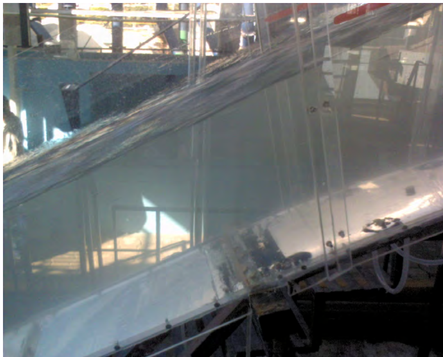
Fig. 3.43 Rápida del modelo hidráulico 1:30 para gasto máximo (Laboratorio de Hidráulica, CFE, 2010)
