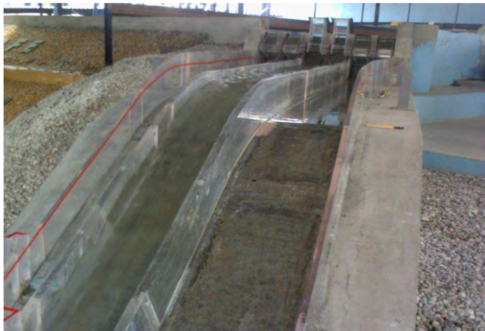
Figura 3.12 Curva vertical del modelo de canal de excedencias 1:75 (Laboratorio de Hidráulica, CFE, 2010)
