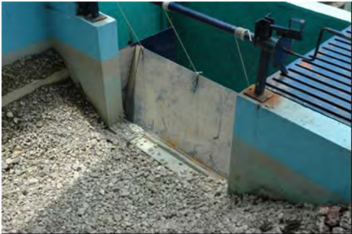
Figura 5.9 Compuerta abatible para simulación del río en el modelo hidráulico (Laboratorio de Hidráulica, CFE, 2007)
