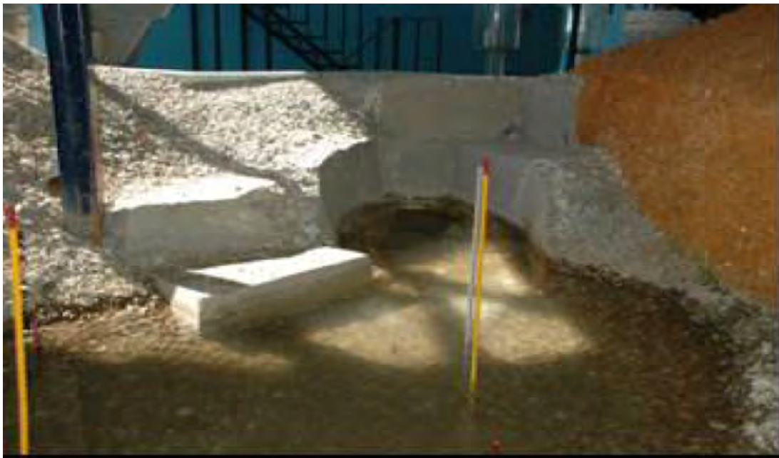
Figura 5.23 Nivel de agua en el desfogue de generación, a la elevación 405.25 msnm (Laboratorio de Hidráulica, CFE, 2007)
