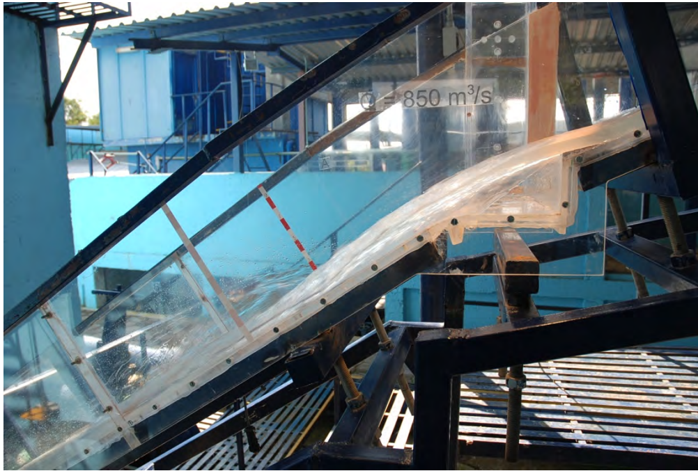
Figura 4.28 Comportamiento del flujo en el canal al pasar por el aireador en modelo hidráulico para un gasto de 850 \text{ (m}^3/\text{s)} en prototipo (Laboratorio de Hidráulica, CFE, 2010)
