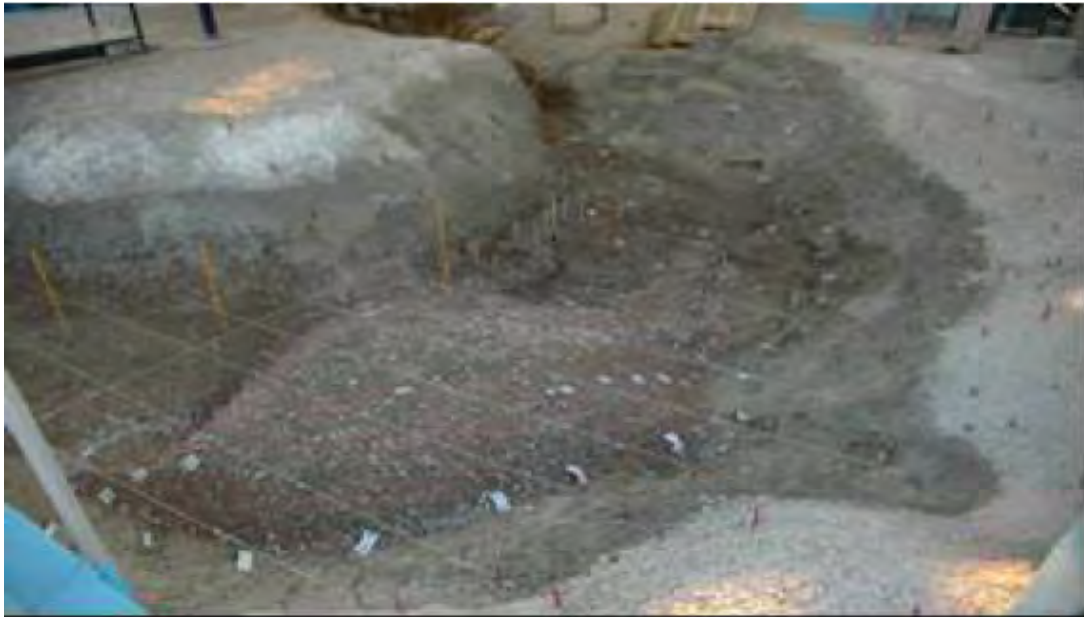
Figura 5.33 Erosión-depósito de material del cauce en modelo hidráulico para un gasto de 5\ 037\ m^3/s por canal, operando los tres canales (Laboratorio de Hidráulica, CFE, 2007)
