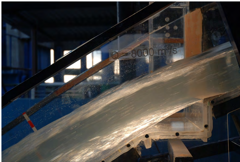
Figura 4.33 Aireador en modelo hidráulico para gasto de 8 000 ( \text{m}^3/\text{s} ) equivalentes a 2 550 ( \text{m}^3/\text{s} ) (Laboratorio de Hidráulica, CFE, 2010)
