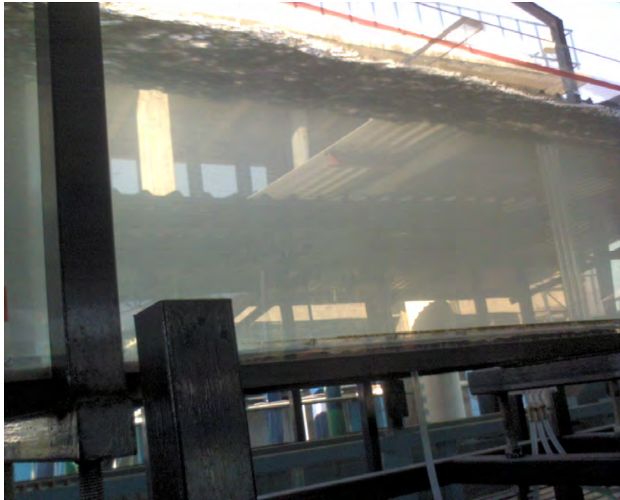
Fig. 3.42 Pendiente subcrítica del modelo hidráulico 1:30 para gasto máximo (Laboratorio de Hidráulica, CFE, 2010)
