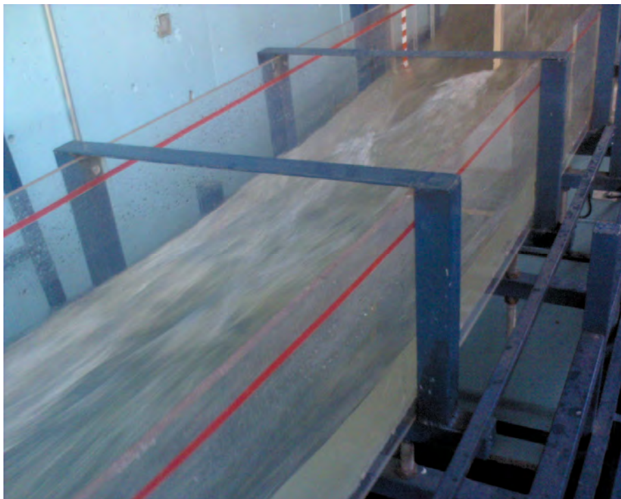
Figura 3.6 Pendiente subcrítica en el modelo de canal de excedencias 1:30 (Laboratorio de Hidráulica, CFE, 2010)
