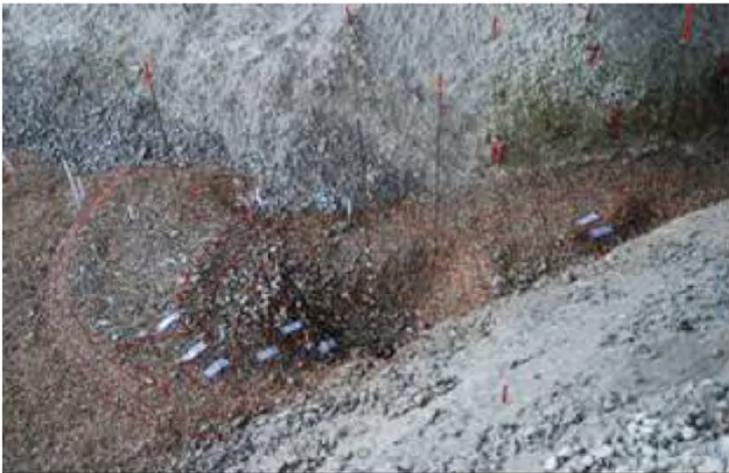
Figura 5.20 Erosión en el cauce en modelo hidráulico para un gasto de 850 m 3 /s por canal central (Laboratorio de Hidráulica, CFE, 2007)
