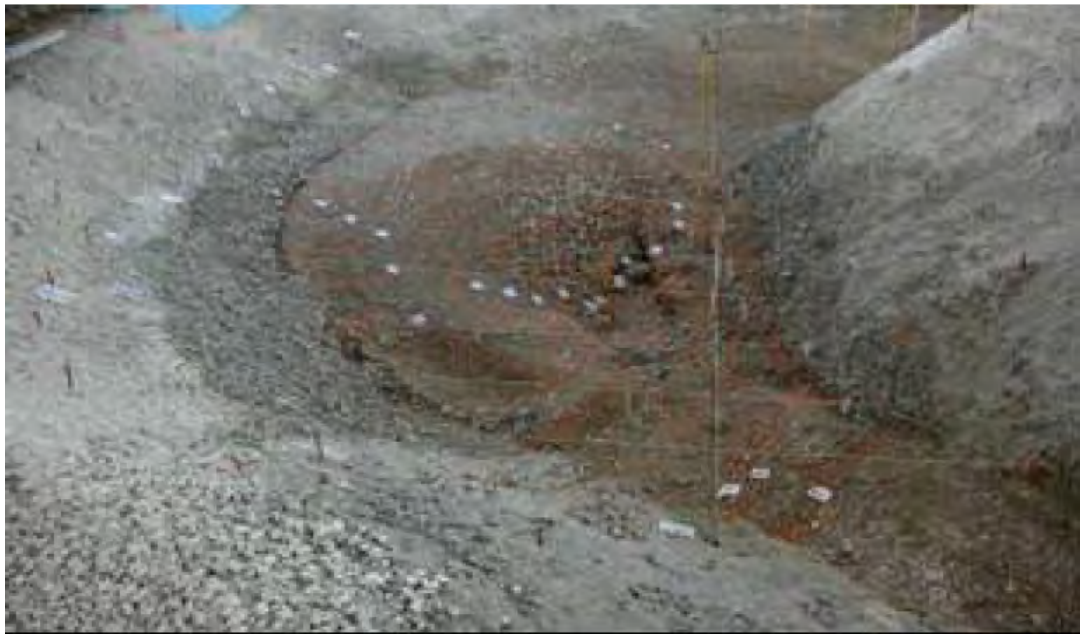
Figura 5.24 Erosión en el cauce en modelo hidráulico para un gasto de 5\ 037\ m^3/s y operando solo el canal central (Laboratorio de Hidráulica, CFE, 2007)
