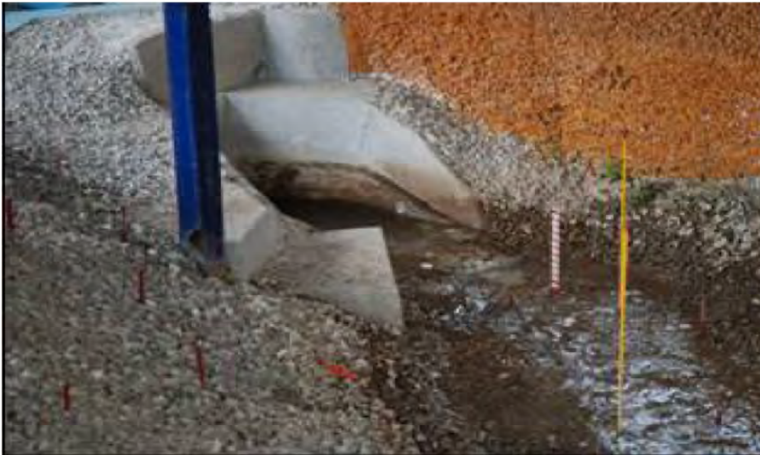
Figura 5.19 Nivel de agua en el desfogue de generación, a la elevación 395.55 msnm (Laboratorio de Hidráulica, CFE, 2007)
