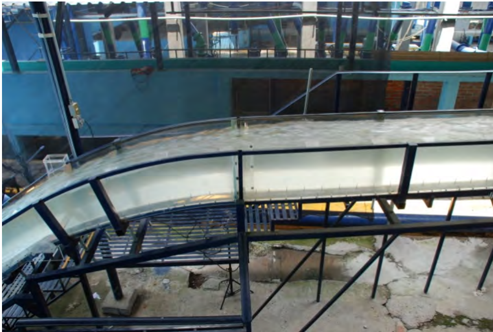
Figura 4.39 Flujo de agua a través de la curva vertical en modelo hidráulico para gasto máximo de 15 110 ( m^3/s ) equivalentes a 5 037 ( m^3/s ) en prototipo (Laboratorio de Hidráulica, CFE, 2010)
