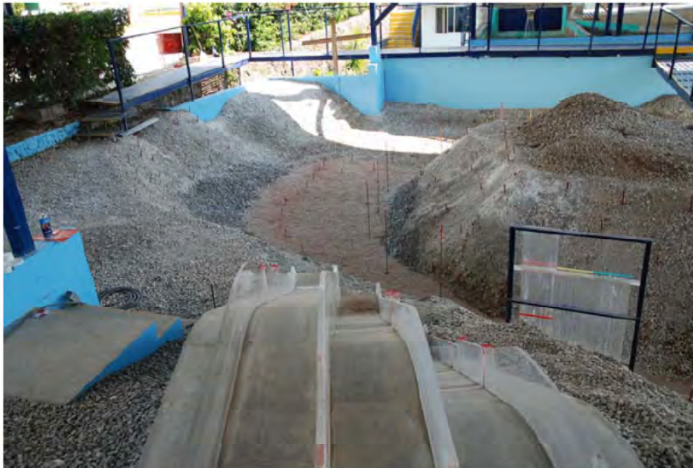
Figura 5.8 Descarga del vertedor sobre el cauce del río (Laboratorio de Hidráulica, CFE, 2007)
