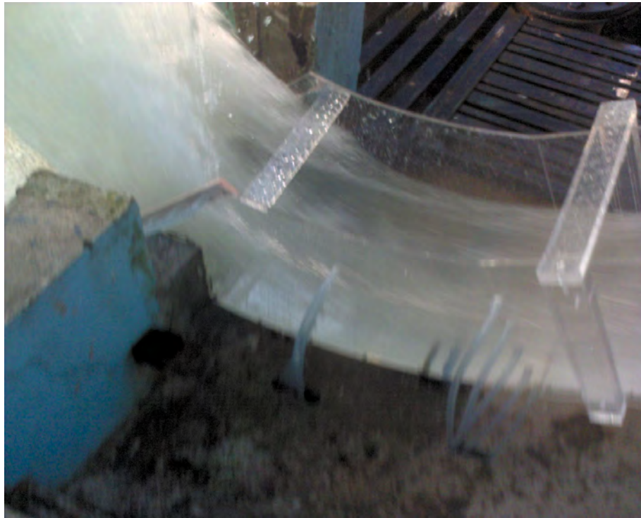
Fig. 3.46 Cubeta deflectora del modelo hidráulico 1:30 para gasto máximo (Laboratorio de Hidráulica, CFE, 2010)
