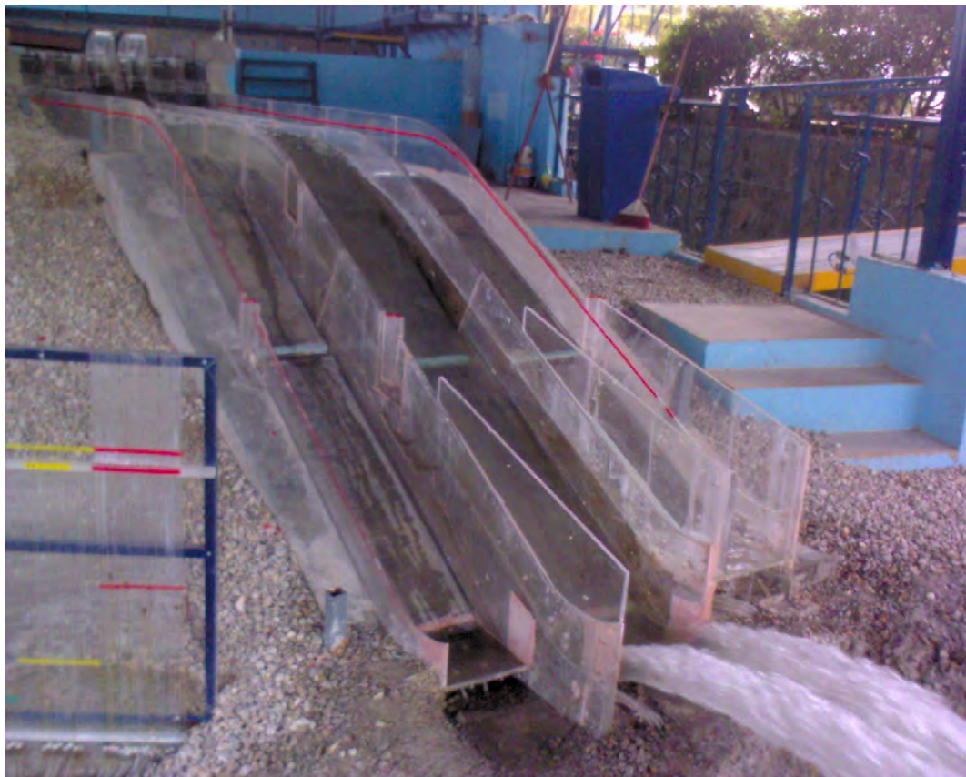
Figura 5.2a Modelo hidráulico del vertedor, escala 1:75 (Laboratorio de Hidráulica, CFE, 2007)
