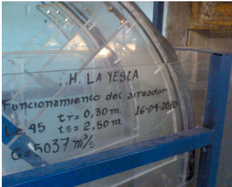
Figura 3.4 Compuerta del vertedor del modelo 1:45 (Laboratorio de Hidráulica, CFE, 2010)
