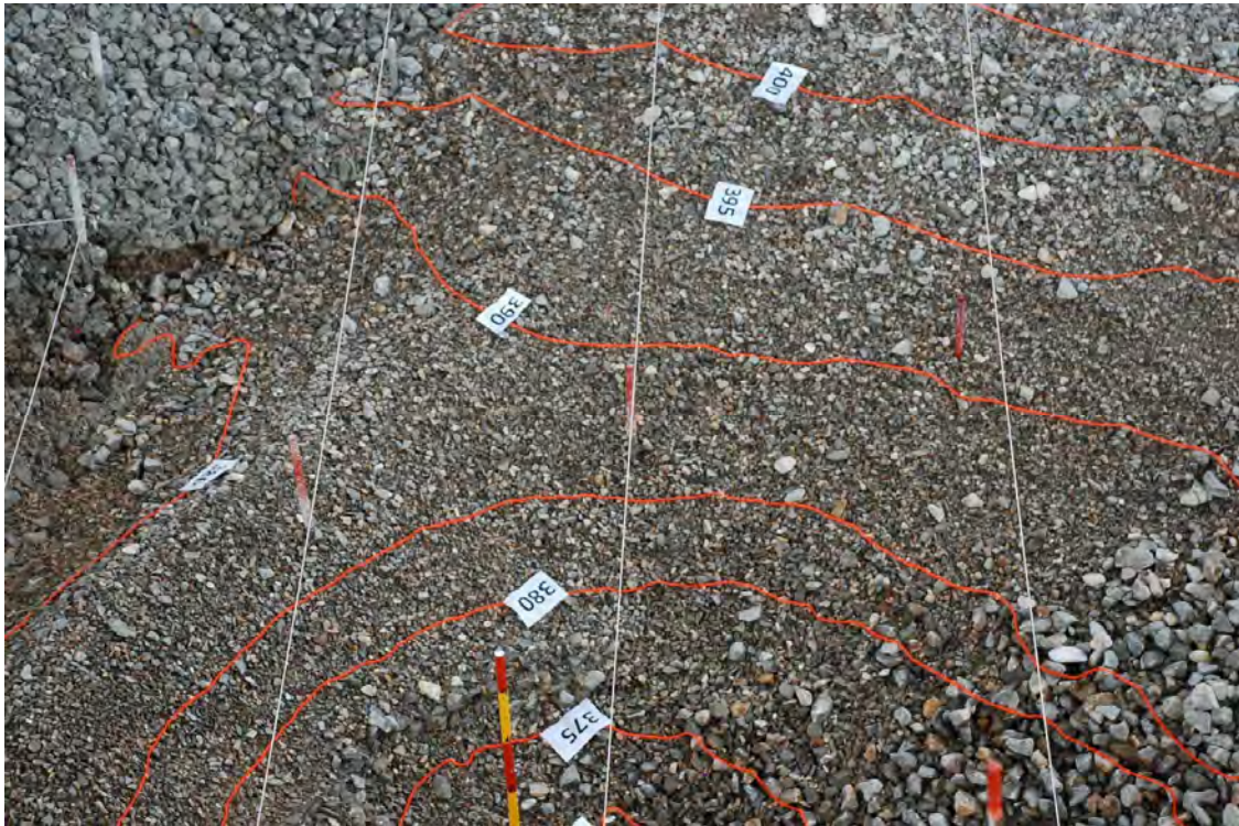
Figura 5.10 Sistema coordinado del cauce y curvas de nivel del río al terminar el ensayo (Laboratorio de Hidráulica, CFE, 2007)
