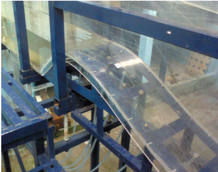
Figura 3.5 Vertedor tipo Creager en el modelo hidráulico 1:30 (Laboratorio de Hidráulica, CFE, 2010)
