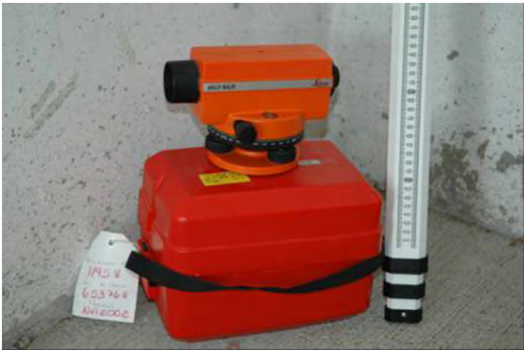
Figura 5.12 Equipo de topografía: nivel fijo con estadal (Laboratorio de Hidráulica, CFE, 2007)
