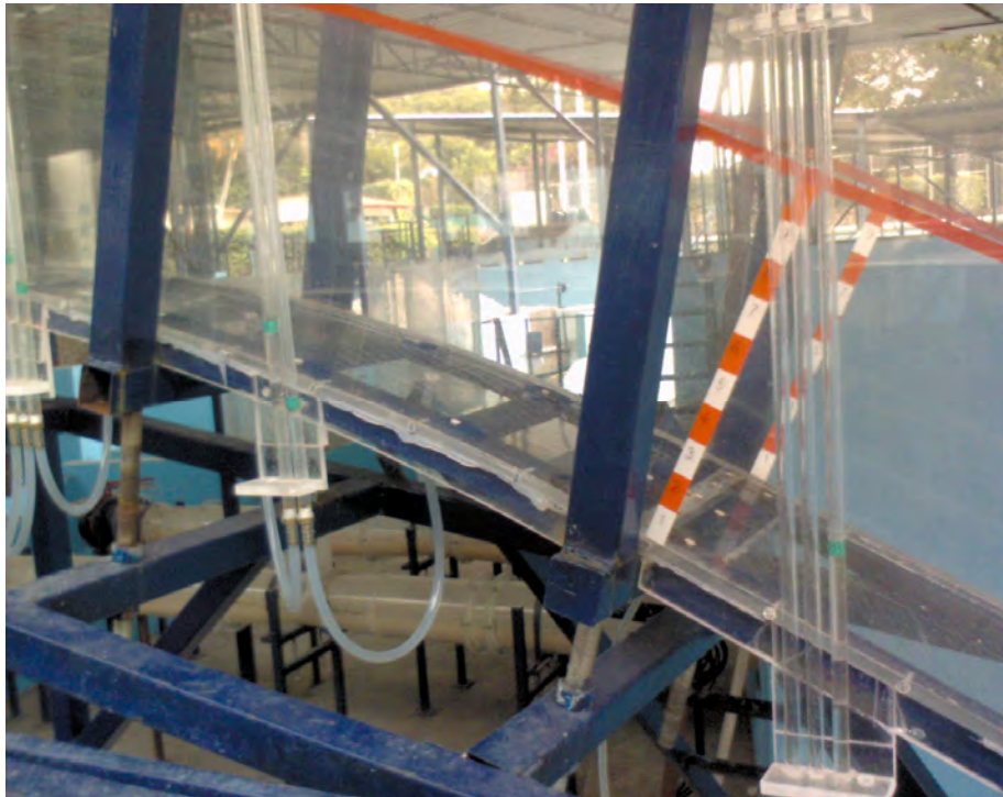
Figura 3.7 Curva vertical del modelo 1:30 (Laboratorio de Hidráulica, CFE, 2010)
