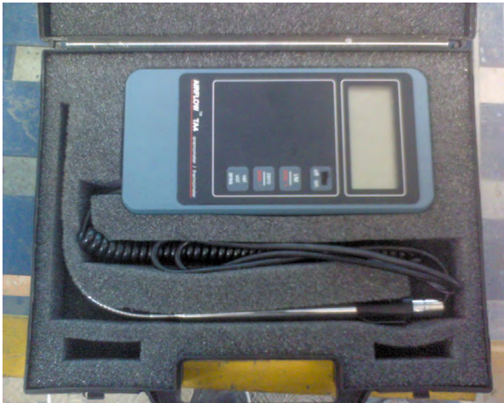
Figura 4.55 Anemómetro digital para medir gasto de aire en la torreta del aireador (Laboratorio de Hidráulica, CFE, 2010)
