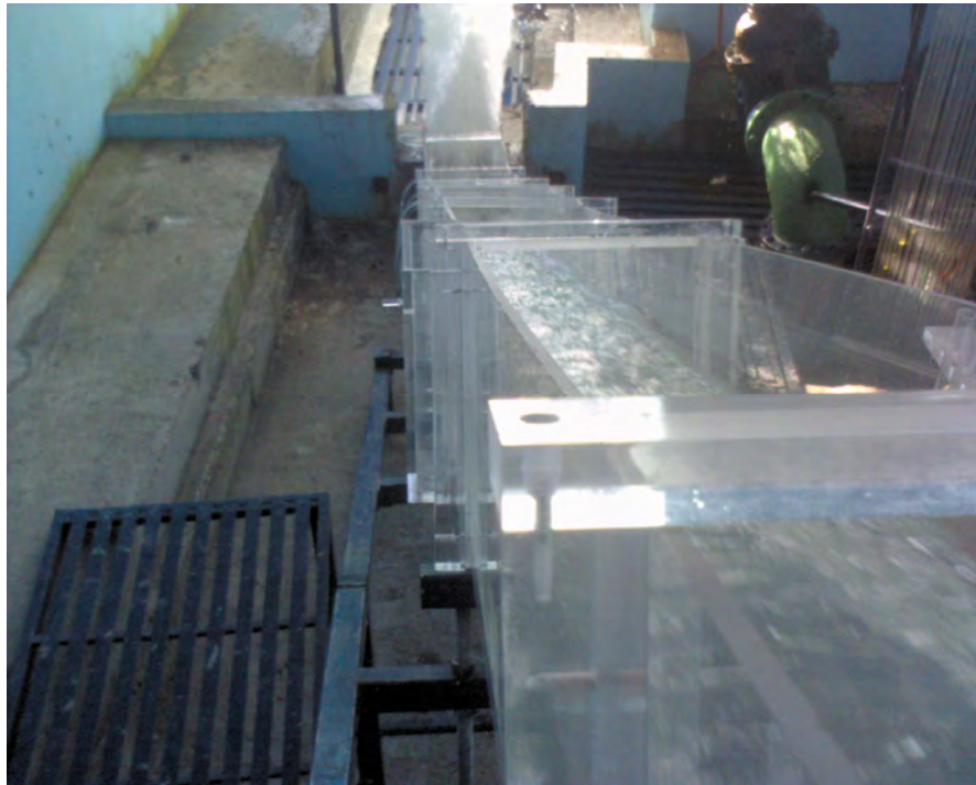
Fig. 3.44 Otra perspectiva de la rápida del modelo hidráulico 1:30 para gasto máximo (Laboratorio de Hidráulica, CFE, 2010)
