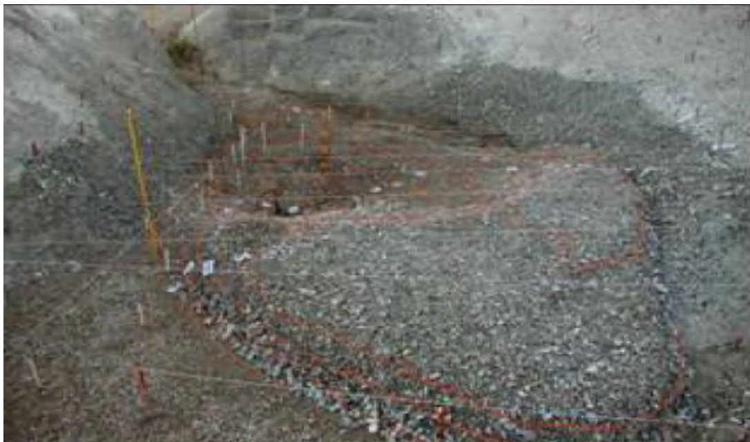
Figura 5.25 Erosión-depósito de material del cauce en modelo hidráulico para un gasto de 5\ 037\ m^3/s y operando solo el canal central (Laboratorio de Hidráulica, CFE, 2007)
