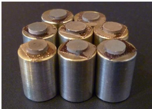
Figura 19 Pastillas de los cementos hidratados recubiertas de oro
