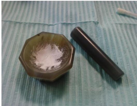
Figura 15 Mortero de ágata con KBr y el material.
