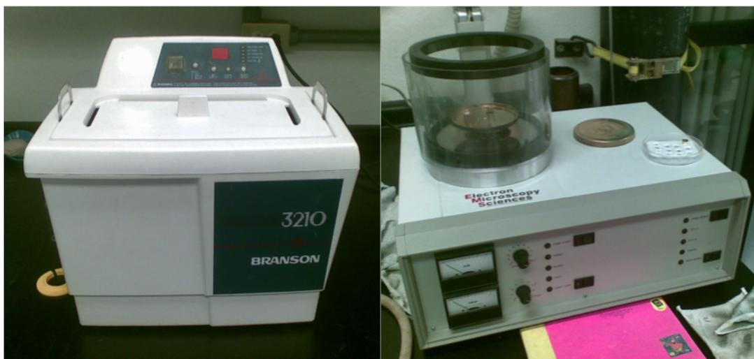
Figura 4.4: Izquierda: Cámara Branson 3210. Derecha: *Sputter Coater* (EMS 550).
