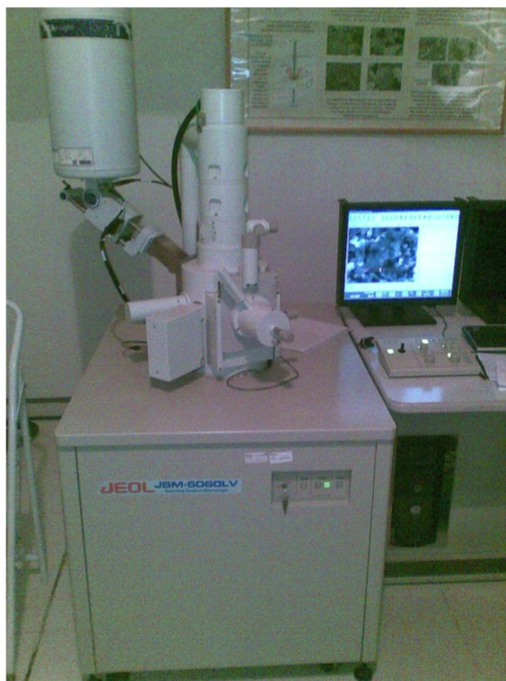
Figura 4.5: Microscopio electrónico de barrido JEOL JSM 6060LV.
