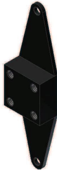
Figura 3.18. Soporte para el equipo de medición.
