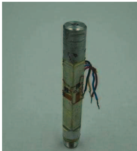
Figura 1.23. Celda de compresión instalada en el equipo de flexión en vigas.
