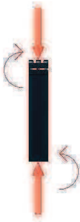
Figura 2.26 Diagramas de cuerpo libre para el análisis de la columna para empotre de viga en cantiléver.
