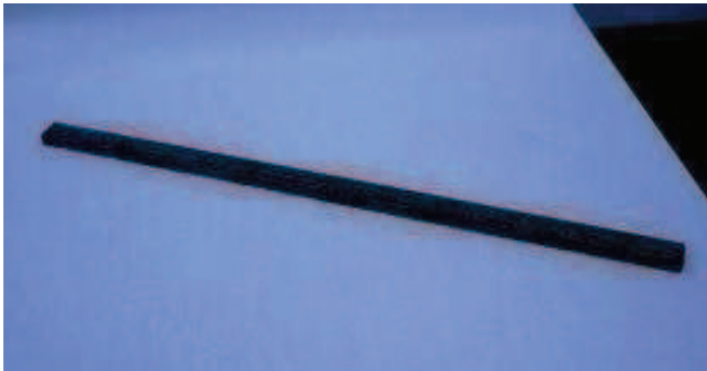
Figura 3.6. Probeta de acero sin instrumentar
