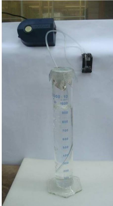
Figura 5. Sistema de bombeo para la captura de CO 2 atmosférico con una solución 0.7M de NaOH libre de CO 3 2- .
