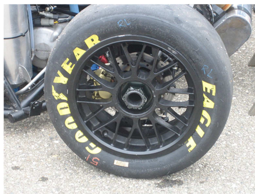
Fig 2. 3 Ejemplo de un rin con una sola tuerca al centro.
