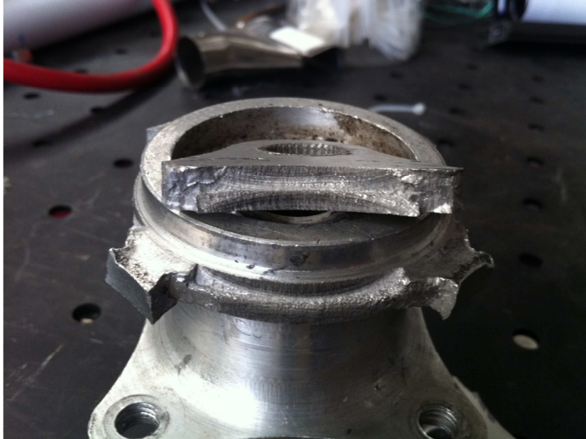
Fig. 7. 3 Fotografía de la maza delantera fracturada.
