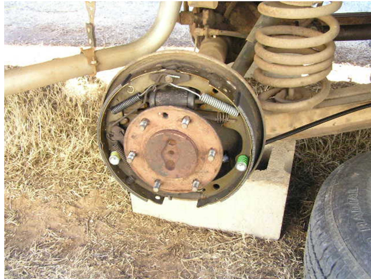
Fig. 3. 1 Freno de tambor desarmado (falta el tambor). Se pueden apreciar las zapatas que friccionan contra él.
