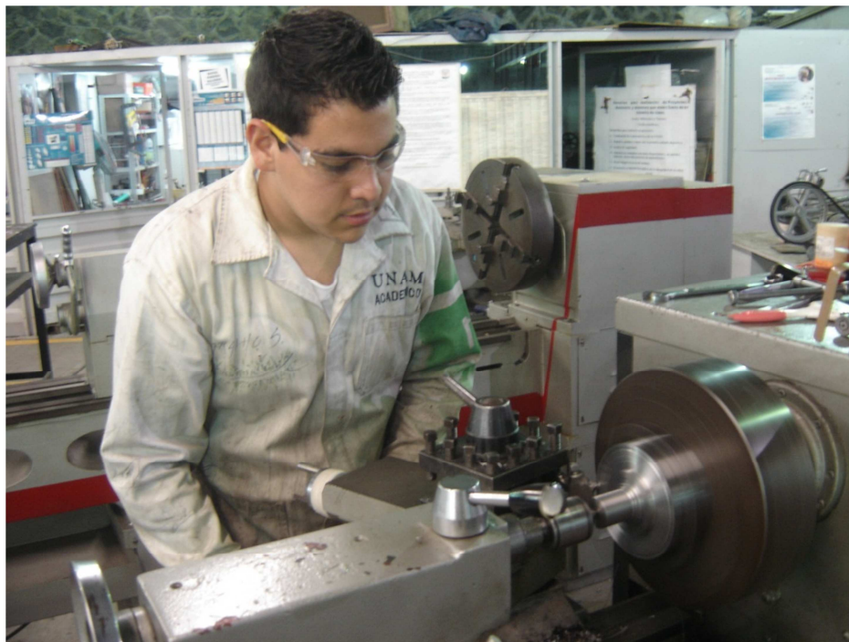
Fig. 6. 1 Maquinado de las mazas en torno en las instalaciones de la FI.
