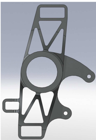
Fig. 4. 10 Mango con cajas para reducción de peso.
