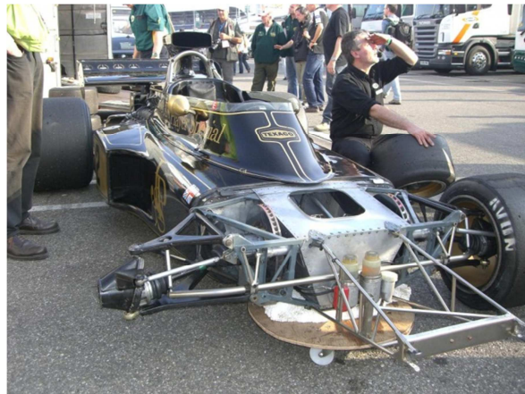
Fig. 1. 2 Ejemplo de frenos inboard . Nótese que los discos de frenado se encuentran dentro de la zona suspendida del vehículo.
