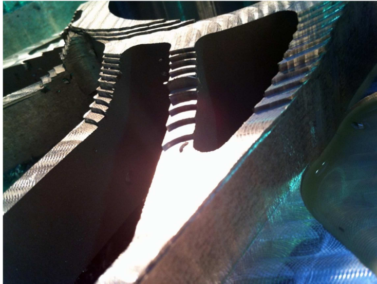
Fig. 6. 4 Detalle de los escalones dejados en el desbaste grueso.
