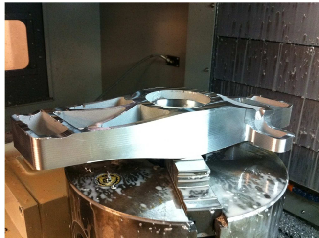
Fig. 6. 5 Mangos durante el maquinado en fresa CNC en las instalaciones del CCADET (izq.) y el Instituto de Ingeniería (arriba).
