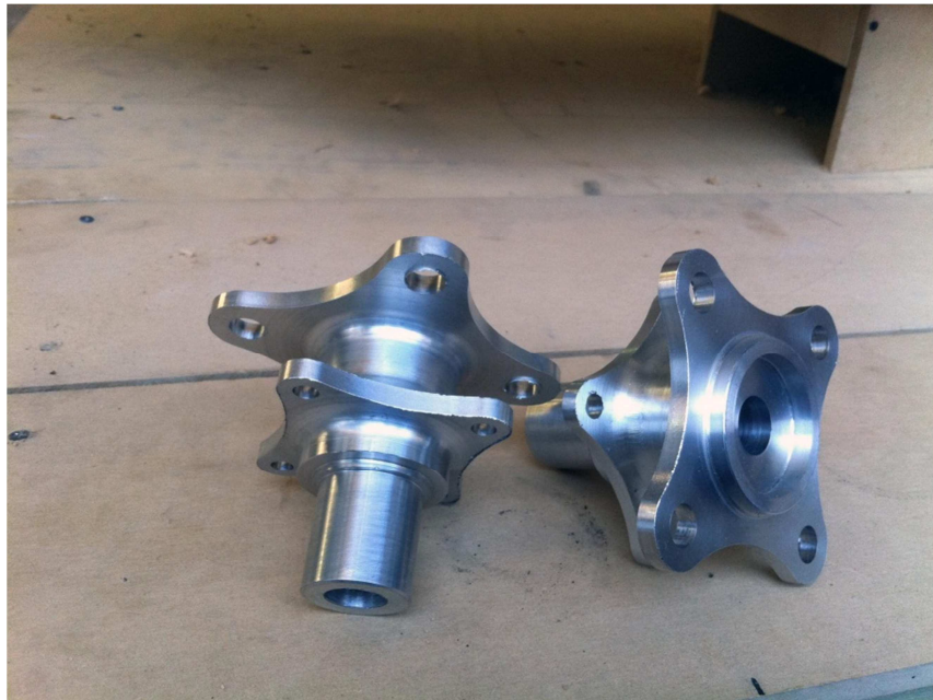
Fig. 6. 2 Mazas delanteras terminadas.
