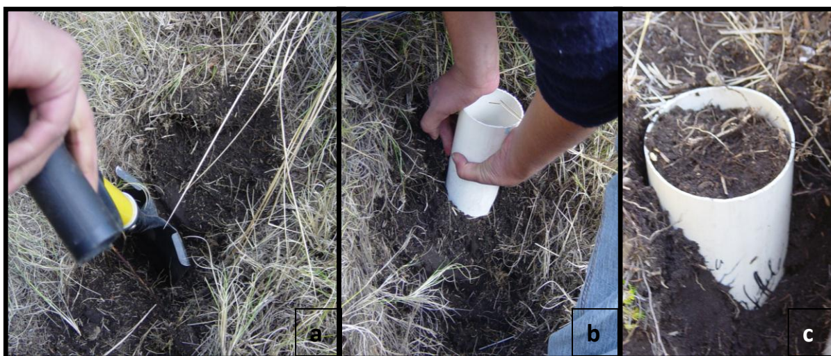
Figura 8. Muestreo de suelo para la evaluación de la biomasa de micelio externo: a) Apertura de espacio, b) introducción del tubo de PVC, c) Retiro del tubo de PVC con la muestra de suelo
