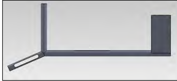
Figura 7.28. Subsistema apoyo con ranura / vista frontal
