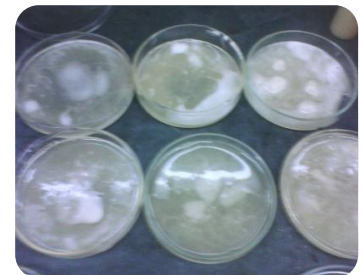
Figura 3.3. Extracción de polímeros obtenidos de cefalotórax y exoesqueleto de camarón
