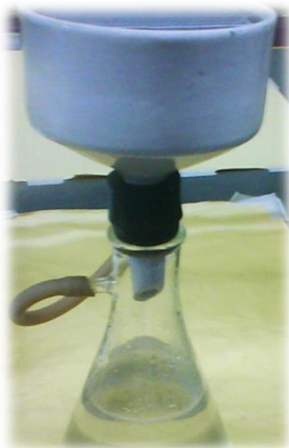
Figura 3. Equipo de filtración y tratamiento de residuos (residuo de color rosa a incoloro)
