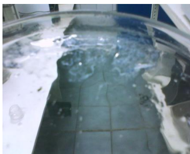
Figura 4.1. Película de quitina experimental obtenida de residuos de camarón
