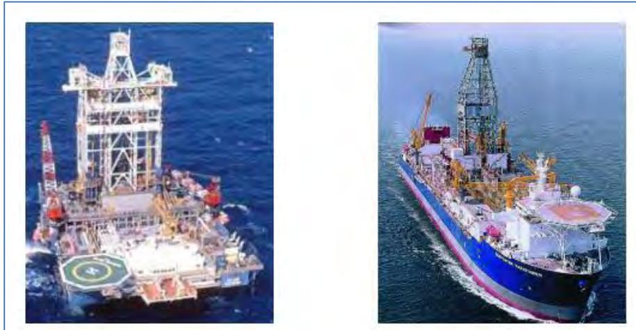
Figura 3.19 Plataforma Semisumergible y Barco de Perforación especializado.
