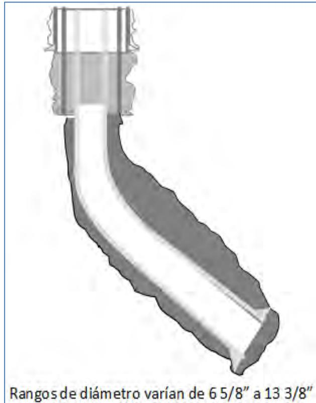
Figura 2.4 Tubería Intermedia.
