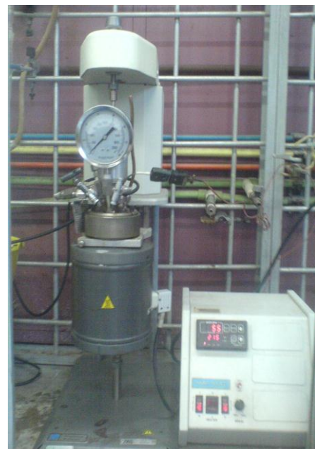
FIGURA 21. Reactor PARR para hidrólisis a temperatura y presión alta.
