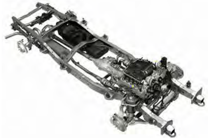
FIGURA 1.3 BASTIDOR MONTADO (CHASIS INDEPENDIENTE) [3]
