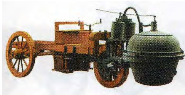
FIGURA 1.1 AUTOMÓVIL DE VAPOR DE CUGNOT DE 1769 [2]
