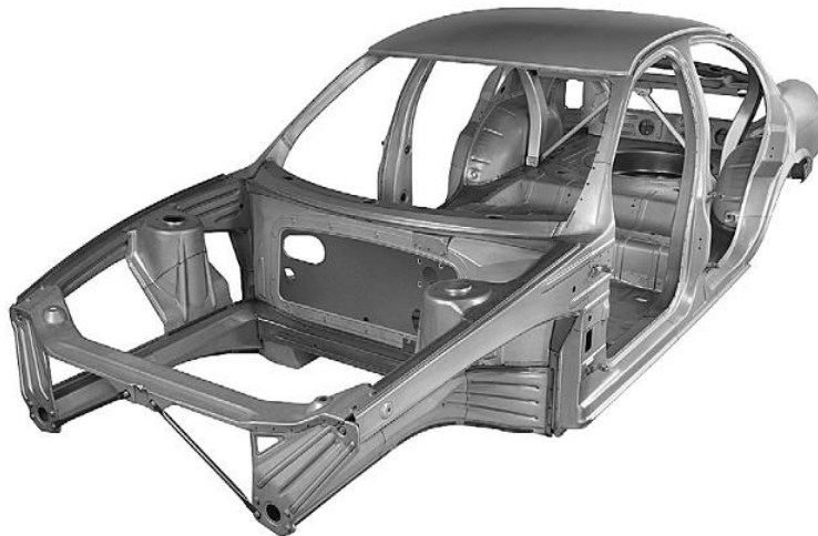
FIGURA 1.10 ESTRUCTURA DE ACERO ULTRALIGERO (ULSAB) [9]
