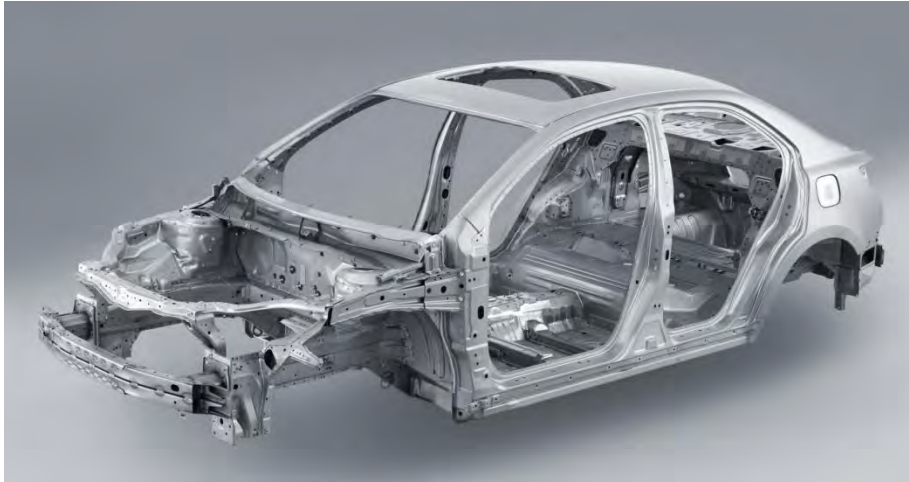
FIGURA 1.6 ESTRUCTURA MONOCASCO FABRICADA EN ACERO DEL AUTOMÓVIL SUZUKI KIZASHI [7]
