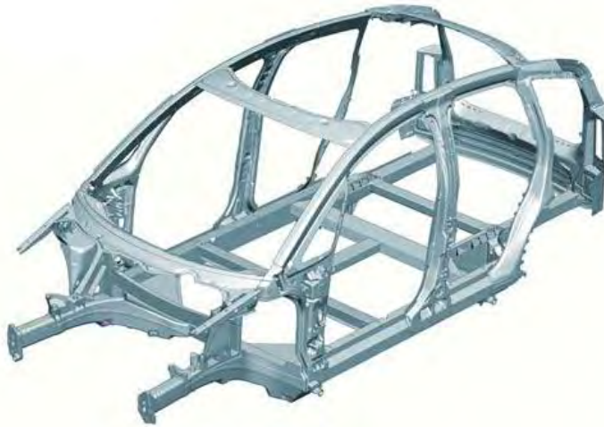
FIGURA 1.7 ESTRUCTURA DE UN AUDI A2 EN ALUMINIO [8]
