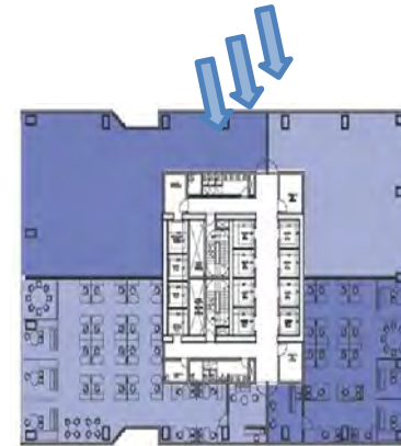
OFICINAS Ventilación Actual: Escasa Ventilación Recomendada: Cruzada
